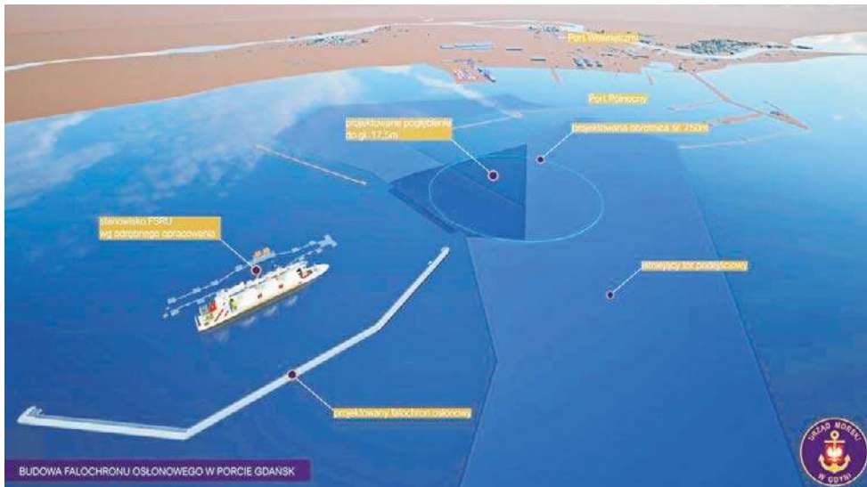
Schemat i lokalizacja pierwszego terminalu FSRU i falochronu w Zatoce Gdańskiej
