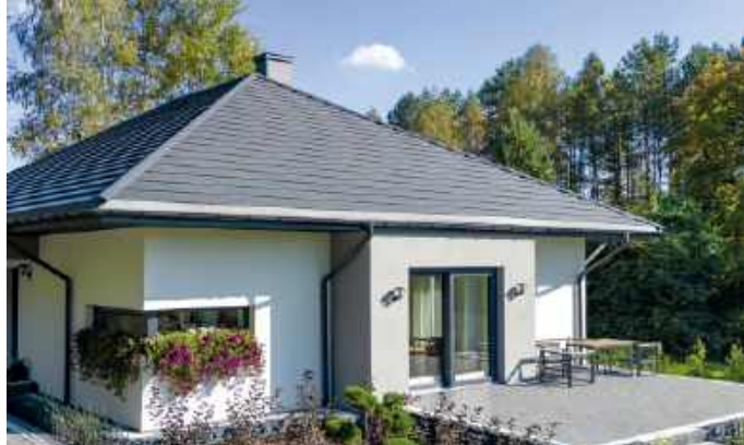
🔗 Na dachach czterospadowych o małej powierzchni rury spustowe montuje się na końcach rynien, a na większych w połowie ich długości. BLACHY PRUSZYŃSKI
