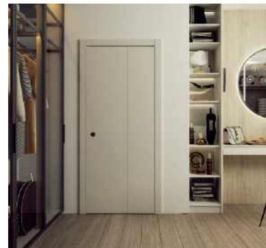
🔗 Drzwi łamane nie są zbyt powszechnie stosowane, jednak sprawdzają się w niektórych wnętrzach. Zamiast klamki mają specjalny pochwyt. ECLISSE, VOSTER
