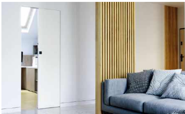
➡ Drzwi przesuwne chowane do kasety w ścianie. Zależnie od wielkości i rozkładu wnętrza, stosuje się wersje jedno- lub dwuskrzydłowe. PORTA
