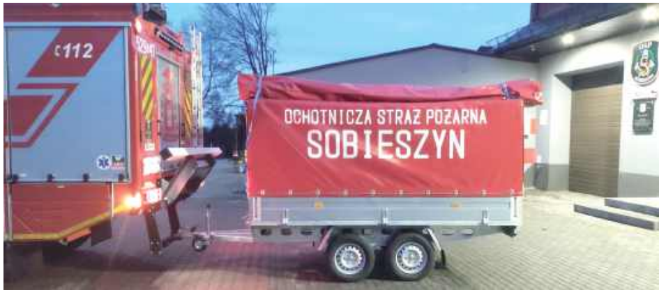
Przyczepka otrzymała podesty i stelaż umożliwiający zabudowę wyposażenia
