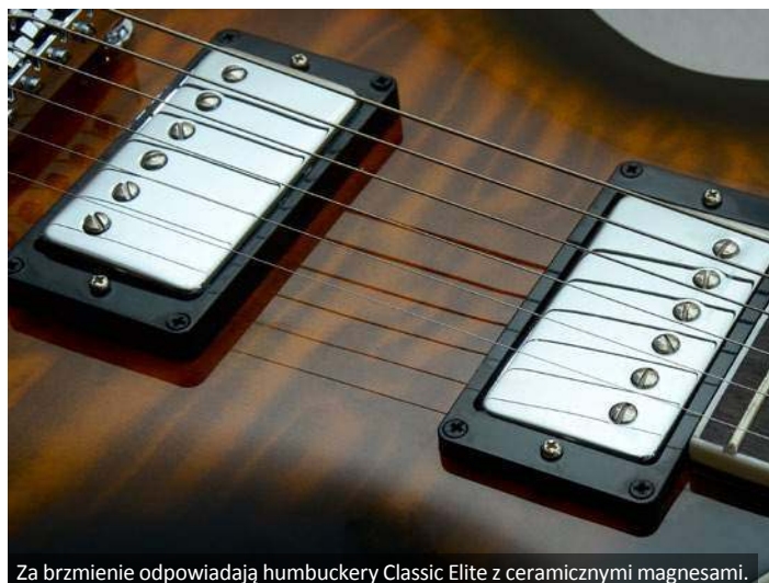
Za brzmienie odpowiadają humbuckery Classic Elite z ceramicznymi magnesami.
