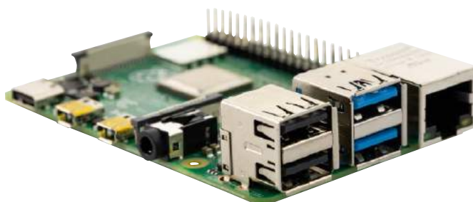
Fotografia 2. Niebieskie kolory przy dwóch portach USB świadczą o zastosowaniu USB 3.0
