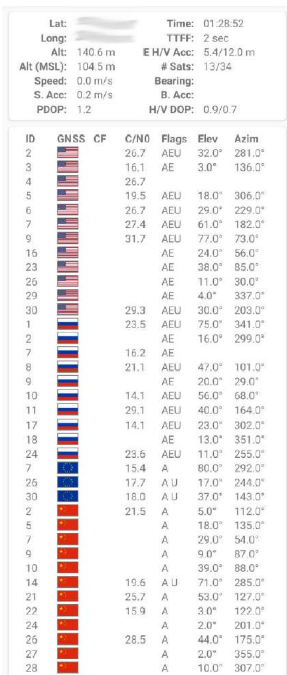
Rysunek 3. Dane sygnałów z satelitów nad Warszawą na urządzeniu obsługującym 4 główne systemy GNSS
