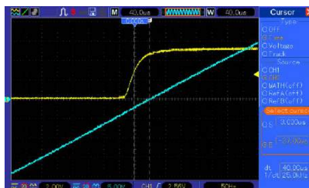
Rysunek 5. Moment przejścia przez zero przy narastaniu napięcia
