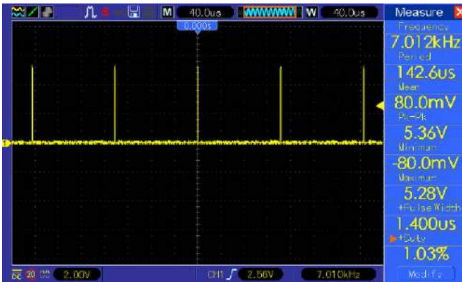
Rysunek 5. Oscylogram przebiegu o częstotliwości 7,01 kHz i wypełnieniu 1%
