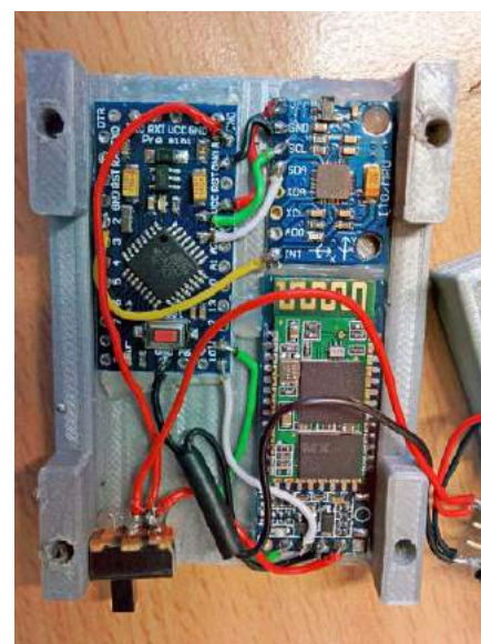
Fotografia 3. Elektronika modułu IMU zamontowana w obudowie
