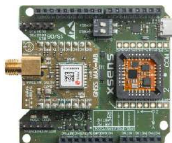
Rysunek 11. Zestaw deweloperski GNSS MTI-7-DK, zgodny z Arduino
