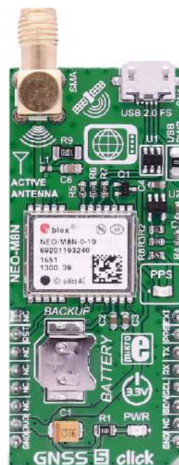
Rysunek 13. Płytkę GNSS 5, CLICK, zgodną z formatem Mikroelektronika click
