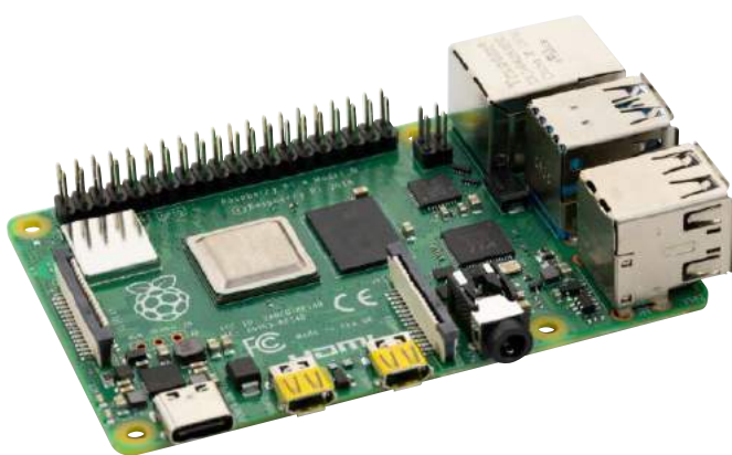
Fotografia 1. Dwa złącza micro HDMI przydadzą się w zastosowaniach domowych i w aplikacjach typu Digital Signage. Warto też zwrócić uwagę na nowe złącze USB Typu C
