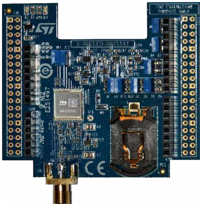
Rysunek 12. Zestaw deweloperski GNSS X-NUCLEO-GNSS1A1 jako rozszerzenie dla płytek STMicroelectronics NUCLEO
