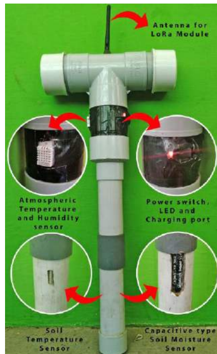
Fotografia 7. Zdjęcie gotowej konstrukcji w obudowie
