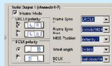
Rysunek 23. Konfiguracja wyjściowego portu szeregowego.
