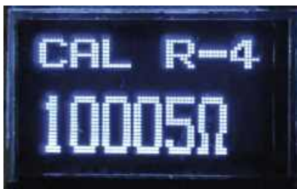
Ekran 5. Podobnie, ten ekran umożliwia zmniejszenie wartości rezystora testu szeregowego. Jeśli wystąpi jakakolwiek zmiana, te dwa kroki są powtarzane do momentu, aż nie zostanie wykryta żadna zmiana
