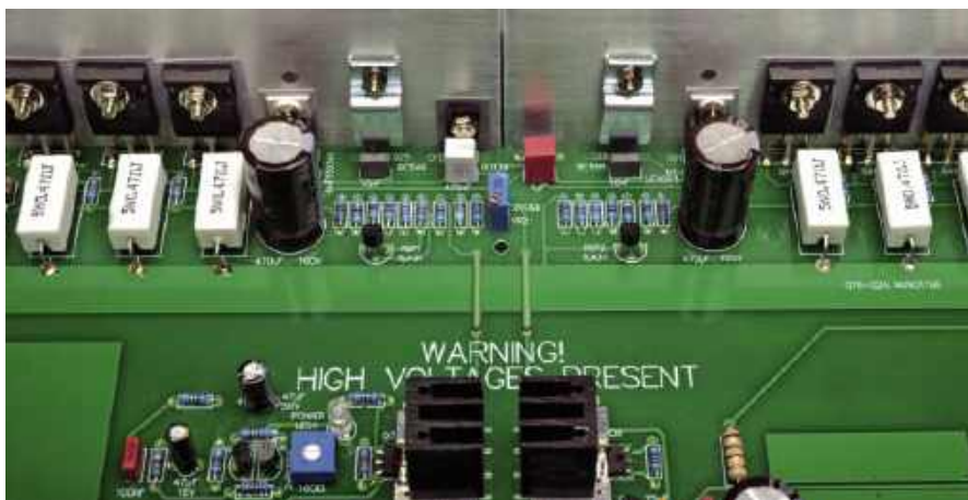
Zbliżenie pokazuje sposób montażu tranzystorów do radiatora
