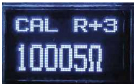
Ekran 4. Zwarcie ramion pęsety w trakcie wyświetlania informacji pokazanej na tym ekranie spowoduje zwiększenie zapisanej wartości szeregowego rezystora testowego w krokach co 1 Ω. Algorytm wyjaśniający ten proces pokazano na rysunku 5
