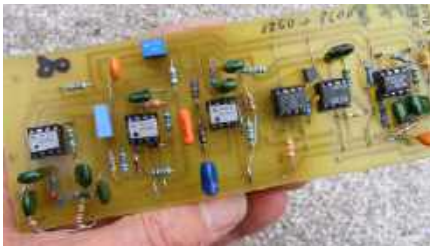
Rysunek 6. Płytkę prototypowego kanału wokodera. W każdym kanale filtry muszą mieć inne wartości kondensatorów. Ostateczna wersja płytki będzie dwustronna, co wyeliminuje mostki drutowe
