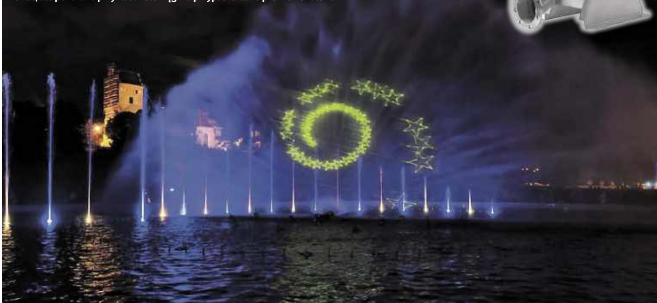
Rysunek 44 i 45. Dysza z sitem wodnym sprzedawana na stronie https://fountains-decor.ie/product/water-screen-nozzle/ . Dysza ma wymiary 930 mm × 528 mm × 802 mm i zapewnia półokrągłe sito z dopływu wody 4000 l/min przy ciśnieniu 12 barów. Grubość warstwy wody wynosi 6 mm. Producent nie określił rozmiaru ekranu, jaki może wyprodukować, ale pokazano przykład. Półokrąg ma przypuszczalnie promień około 10 m
