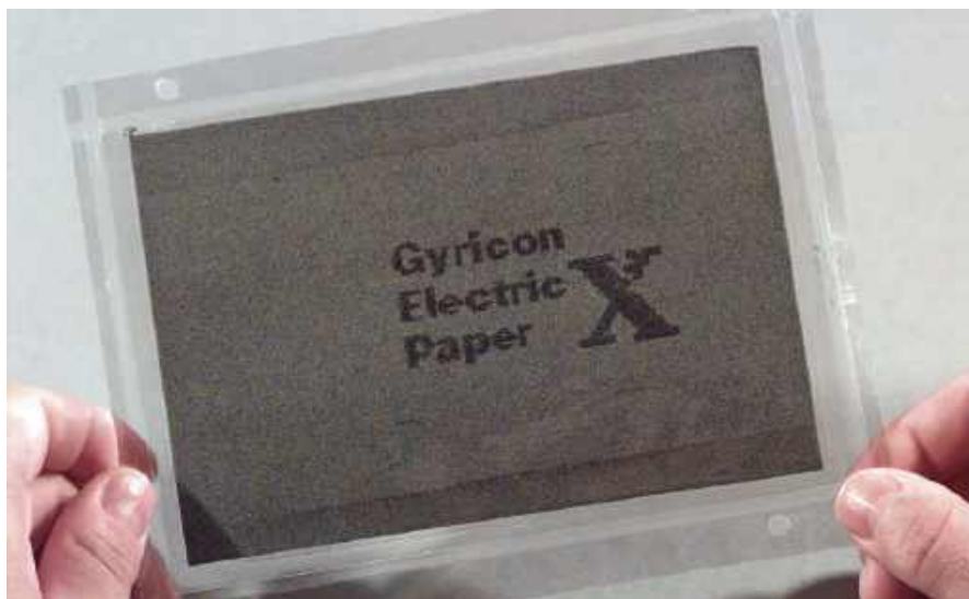
Rysunek 41. Xerox Gyricon, pierwszy papier elektroniczny. Źródło: Strona internetowa Xerox zarchiwizowana z 2005 r.
