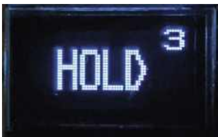
Ekran 8. Plecenie zwarcia końcówek w celu skalibrowania ich rezystancji styku. W przeciwnym razie zapisana wartość nie zostanie zmieniona
