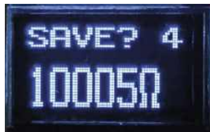
Ekran 6. Żądanie potwierdzenia chęci zapisania wprowadzonej wartości w pamięci nieulotnej Flash. W tym celu należy złączyć ramiona pęsety
