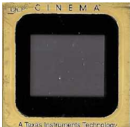
Rysunek 34. Przód układu DMD firmy Texas Instruments do zastosowań kinowych. Źródło: Wikimedia user Binant, CC BY-SA 4.0
