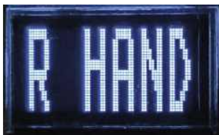
Ekran 1. Pierwszy ekran po włączeniu pęsety to komunikat HAND, zorientowane zgodnie z ustawieniem. Pozostawienie otwartych końcówek oznacza obsługę prawą ręką
