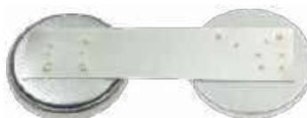
6. Spawanie taśmy niklowej do ogniwa guzikowego
