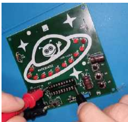
Fotografia 6. Sposób przyłożenia sond pomiarowych multimetru do odpowiednich pinów podstawki mikrokontrolera (sonda czerwona do pinu 20, sonda czarna do pinu 10). Przycisk SW1 ustawiony w pozycji „ON” (załączony)
