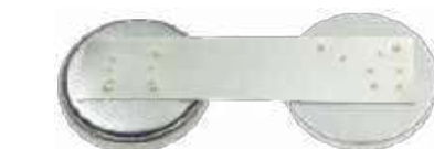
6. Spawanie taśmy niklowej do ogniwa guzikowego
