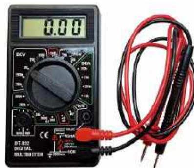
Fotografia 5. Multimetr ustawiony w tryb woltomierza w zakresie pomiarowym „do 20 V” napięcia stałego (DCV) w celu przeprowadzenia pomiaru napięcia między nogą 20 (VCC) i 10 (GND) podstawki pod mikrokontroler IC1
