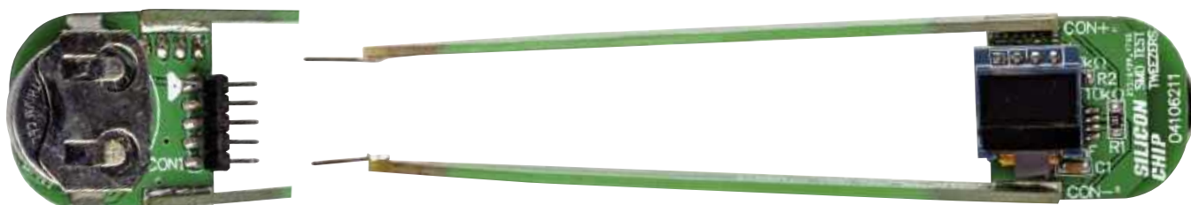
Do uzyskania solidnego zaokrąglenia pomocne jest nałożenie dodatkowej cyny bezpośrednio na podkładkę ramion pęsety
