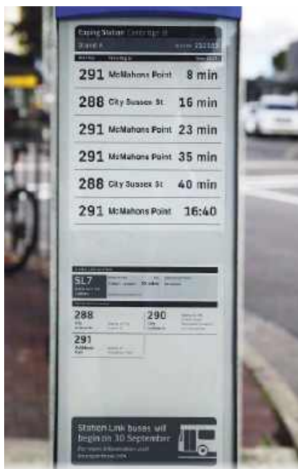
Rysunek 40. Elektroniczny papierowy rozkład jazdy w czasie rzeczywistym używany w autobusach w Sydney. Źródło: Wikimedia user MDRX, CC BY-SA 4.0
