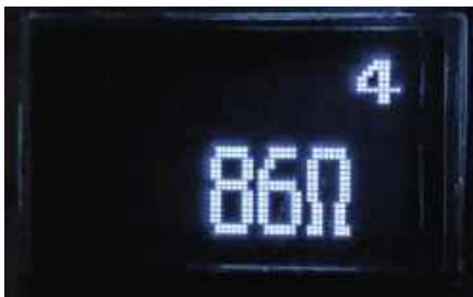
Ekran 9. Rezystancja styków jest uśredniana z około 20 pomiarów. Pokazana tu wartość jest wyższa niż domyślna wartość 16 Ω
