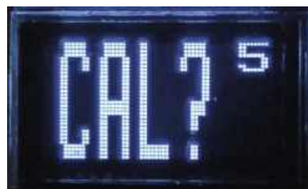
Ekran 3. Pierwsze polecenie dotyczy zakończenia procesu kalibracji i towarzyszy mu nominalny pięciosekundowy licznik czasu. Jeśli końcówki pozostaną otwarte w tym czasie, kalibracja zostanie pominięta
