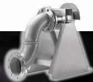
Rysunek 44 i 45. Dysza z sitem wodnym sprzedawana na stronie https://fountains-decor.ie/product/water-screen-nozzle/ . Dysza ma wymiary 930 mm × 528 mm × 802 mm i zapewnia półokrągłe sito z dopływu wody 4000 l/min przy ciśnieniu 12 barów. Grubość warstwy wody wynosi 6 mm. Producent nie określił rozmiaru ekranu, jaki może wyprodukować, ale pokazano przykład. Półokrąg ma przypuszczalnie promień około 10 m
