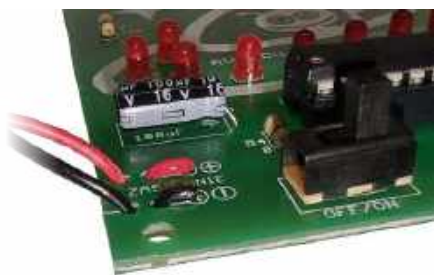
Fotografia 8. Podłączenie kabelków baterii do płytki PCB
