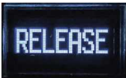
Ekran 2. W różnych momentach podczas konfiguracji może zostać wyświetlone polecenie zwolnienia pęsety („RELEASE”) poprzez otwarcie jej końcówek. Zapobiega to przypadkowemu wprowadzeniu wielu ustawień
