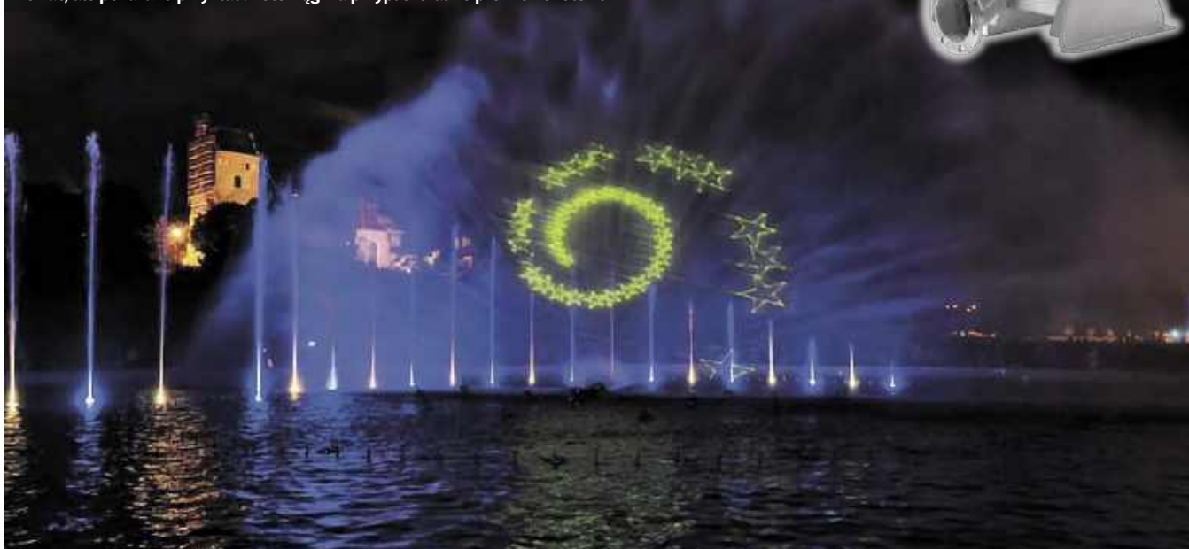
Rysunek 44 i 45. Dysza z sitem wodnym sprzedawana na stronie https://fountains-decor.ie/product/water-screen-nozzle/ . Dysza ma wymiary 930 mm × 528 mm × 802 mm i zapewnia półokrągłe sito z dopływu wody 4000 l/min przy ciśnieniu 12 barów. Grubość warstwy wody wynosi 6 mm. Producent nie określił rozmiaru ekranu, jaki może wyprodukować, ale pokazano przykład. Półokrąg ma przepuszczalność promień około 10 m
