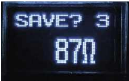
Ekran 10. Jeśli nie pojawi się ten komunikat, pęseta wykryła, że końcówki mogły zostać otwarte, więc zmierzona wartość jest niedokładna
