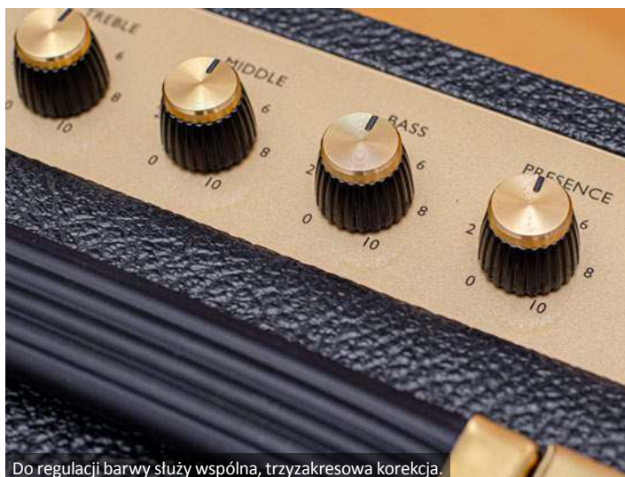
Do regulacji barwy służy wspólna, trzyszakresowa korekcja.
