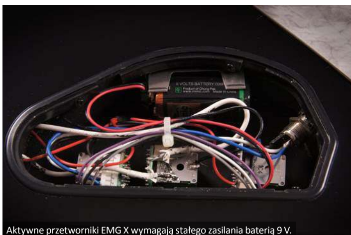
Aktywne przetworniki EMG X wymagają stałego zasilania baterią 9 V.
