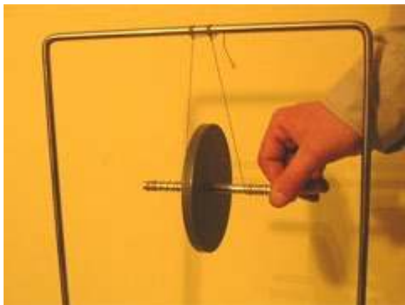
Fot. 1. Tematem artykułu jest zamiana energii kinetycznej w potencjalną, jak w tzw. wahadle Maxwella (a), albo w kulce przetaczającej się wewnątrz „ludzika” schodzącego po schodach (b). Foto: Szymon Wierzejski.
