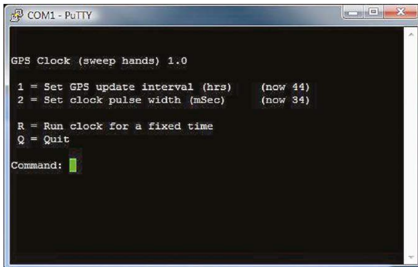
Rysunek 10. Menu ustawień dla zegarów z płynącym sekundnikiem; jest znacznie prostsze niż pokazane na rysunku 9, między innymi nie zawiera opcji zmiany czasu i strefy czasowej. Zawiera za to opcję uruchomienia zegara na określony czas, potrzebną do sprawdzenia czy zegar nie gubi impulsów przy zasilaniu go napięciem około 2 V (patrz opis w tekście).
