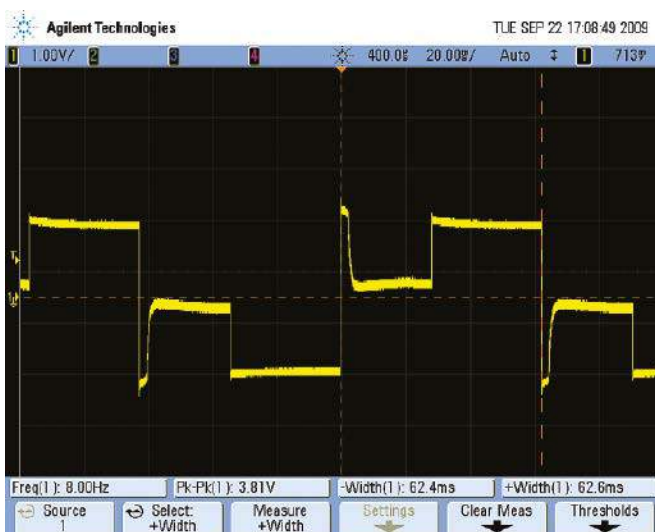
Rysunek 6. Ten sam pomiar jak na rysunku 5, ale z podłączonym mechanizmem zegarowym. Widać przebiegi na indukcyjności cewki na tylnych zboczach impulsów sterujących. Amplituda przebiegów jest ograniczana przez diody Schottky'ego (D3 i D4).
