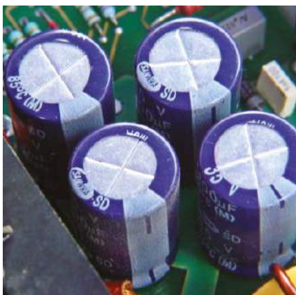
Rysunek 6.6. Cztery duże kondensatory elektrolityczne połączone równolegle w celu utworzenia dużej pojemności filtrującej na wejściu wysokomocowego zasilacza impulsowego DC.
