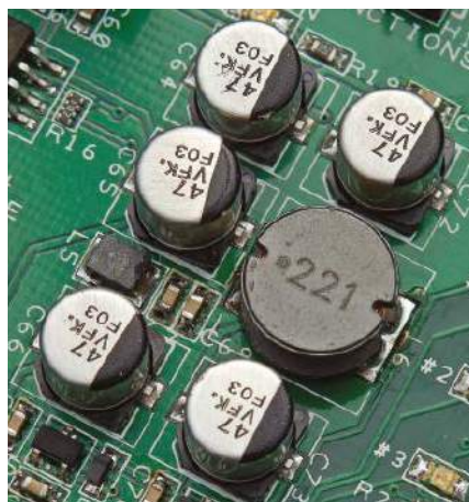
Rysunek 6.7. Kondensatory filtrujące montowane powierzchniowo w zasilaczu impulsowym małej mocy.
