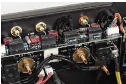
W tylnej części zainstalowano mniejsze moduły wejść oraz zabezpieczenia wyjściowe.
