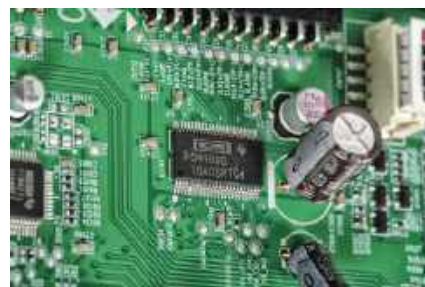
Przetwornik C/A do 8-kanalowy układ Texas Instruments PCM1690.
