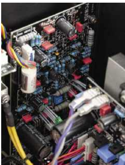
W tylnej części zainstalowano mniejsze moduły wejść oraz zabezpieczenia wyjściowe.
