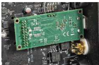
Interfejs wejściowy USB został umieszczony na niezależnej płytce.
