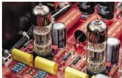
Bufory lampowe bazują na dwóch podwójnych triodach.
