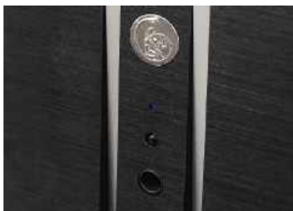
Pomiędzy dwoma przetłoczeniami, obok dyskretnych diod, znajduje się wyjście słuchawkowe (gniazdo 6,3-mm).
