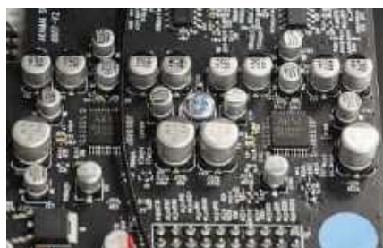
Przetworniki C/A to układy AKM AK4493.
