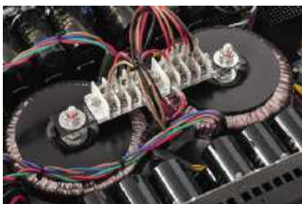
H30A to pełny układ dual-mono, z parą transformatorów o mocy 1 kW każdy.
