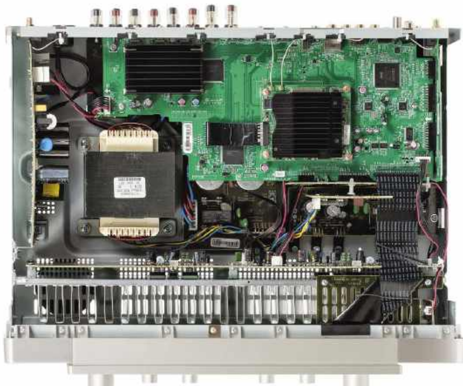
Konstrukcja Stereo 70s wywodzi się z amplitunerów wielokanałowych. Ograniczono liczbę końcówek mocy i usunięto dekodery surround.
