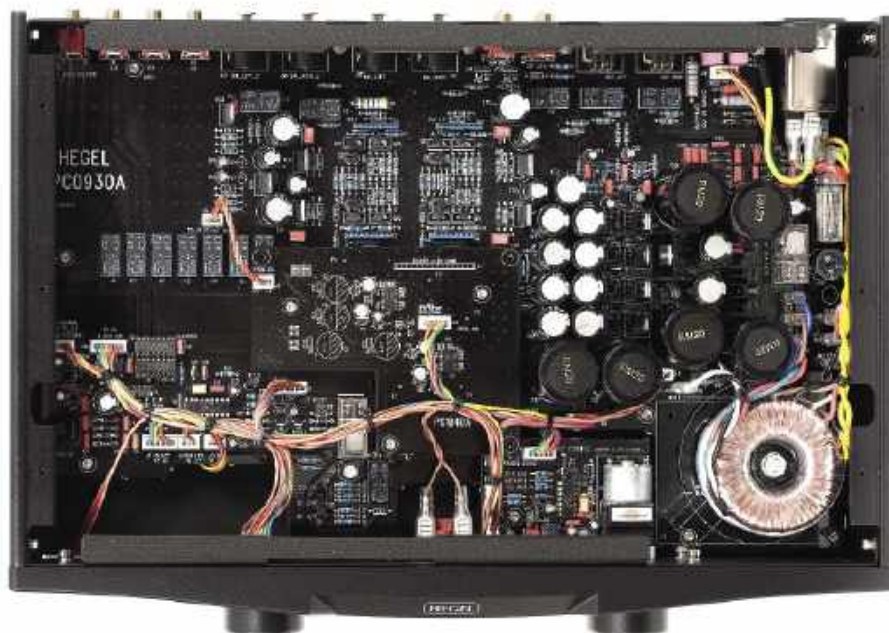
Stopień wzmacnienia zbudowano na tranzystorach FET. Zasilanie jest liniowe.
