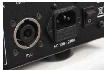
Dodatkowe oryginalne gniazdo jest przeznaczone dla zewnętrznego zasilacza PSU.
