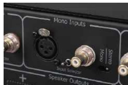
Wygodnym rozwiązaniem jest niezależne (również w wariantach RCA i XLR) wejście monofoniczne dla trybu mostkowego.
