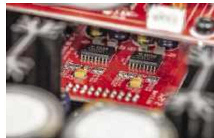
Analogowa regulacja głośności jest zbudowana na scalonych regulatorach Burr Brown.
