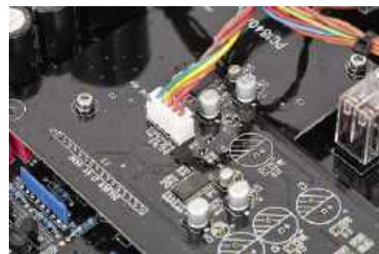
Moduł regulatora głośności składa się z dwóch układów scalonych.
