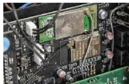
Podobnie jest z modułami sieciowymi i Bluetooth, które zostały zaekranowane.
