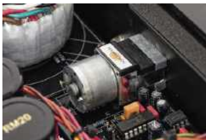
Potencjometr Alps jest sterownikiem bardziej skomplikowanego układu regulacji głośności.
