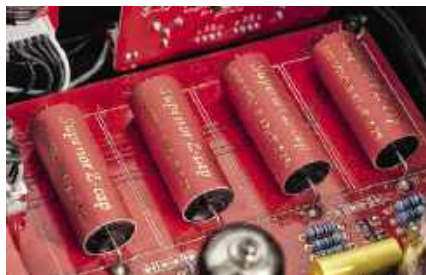
Kondensatory separujące elementy Jantzen z serii Superior Z-Cap.
