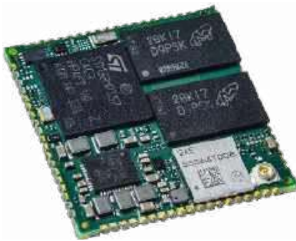
Fotografia 4. Minikomputer SoM jako przykład modułu OEM o dużej gęstości upakowania elementów ( https://t.ly/EAzns )
