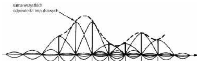
Rysunek 6. Odtworzenie oryginalnego przebiegu na wyjściu przetwornika
