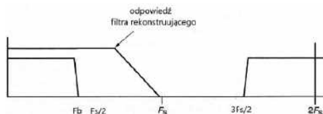
Rysunek 12. Odpowiedź częstotliwościowa filtra rekonstruującego przy nadpróbkowaniu 2-Fs
