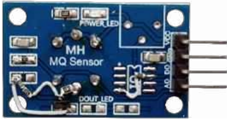
Fotografia 1. Płytkę modułu modMQ-7 po modyfikacji (opis w tekście)
