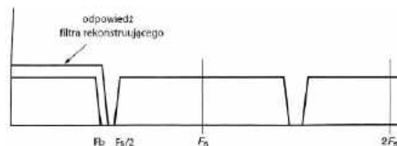
Rysunek 11. Odpowiedź częstotliwościowa rzeczywistego filtra rekonstruującego
