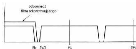
Rysunek 11. Odpowiedź częstotliwościowa rzeczywistego filtra rekonstruującego
