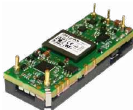
Fotografia 3. 300-watowa przetwornica DC/DC marki TDK Lambda do montażu przewlekane na płycie bazowej docelowego urządzenia ( https://t.ly/3csPt )
