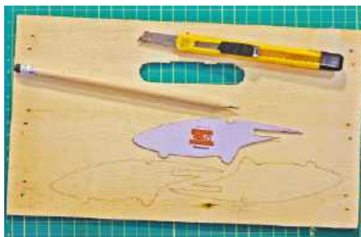
Po wycięciu szablonu kadłuba odrysowujemy go na lekkiej sklejkce i wycinamy piłąk włoścnicową (przy odrobinie zacięcia i cierpliwości nawet nożykiem do tapet)
