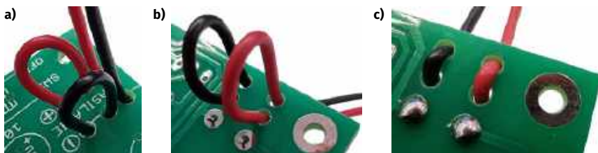
Fotografia 15. Kabelki złącza baterii należy a) przeprowadzić przez otwory pomocnicze od strony komponentów, b) następnie patrząc „od spodu” przetożyć je przez kolejną parę otworów, c) i na końcu przylutować odizolowane i pocynowane wcześniej końcówki kabelków do odpowiednich pól lutowniczych na płytce PCB
