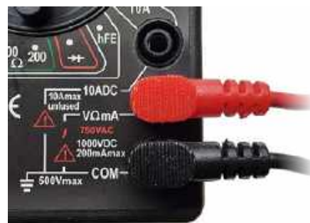
Fotografia 16. Poprawne podłączenie kabli na przykładzie multimetru DT-830B ustawionego na funkcję woltomierza napięć stałych
