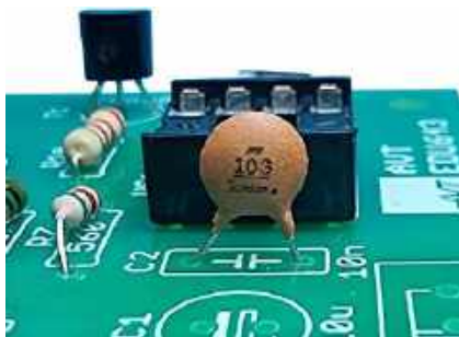
Fotografia 8. Montaż kondensatora stałego C2. Kierunek montażu jest obojętny. Na obudowie kondensatora widać napis „103” informujący o pojemności 10 i 3 zera pikofaradów (10000 pF) czyli 10 nF
