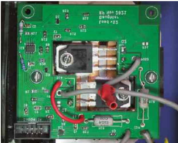
Rysunek 15. Płyta dodatkowa ma dwa moduły zasilania i układ scalony monitora prądu, identyczne z tymi na płycie głównej. Sygnały sterujące oraz z czujników są przesyłane do płyty głównej tasiemką. Należy zauważyć, że układ płyty głównej uległ znacznym zmianom od czasu wykonania zdjęcia
