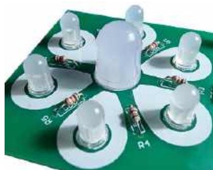
Fotografia 12. Poprawnie zamontowane diody LED. Kierunek montażu wszystkich diod LED należy dopilnować zgodnie z opisem powyżej. W centralnej części kwiatka należy zamontować największą diodę LED, tę o średnicy 10 mm
