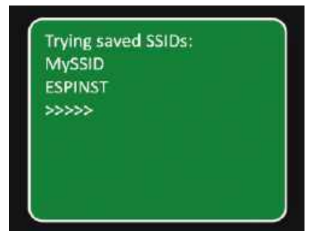
Ekran 7. Po zaprogramowaniu płytki sterownika, po pierwszym włączeniu zasilania powinien zostać wyświetlony powyższy ekran. Jest to program próbujący połączyć się z lokalnym adresem Wi-Fi LAN
