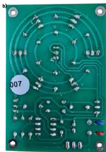
Fotografia 19. Poprawnie zmontowany układ Dwukolorowego kwiatka LED. Widok płytki a) od strony komponentów, b) od strony lutowania
