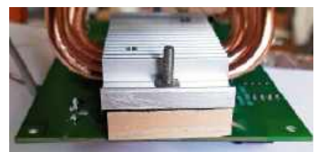
Blok montażowy chłodzenia CPU do PCB o grubości 9 mm wykonany z płyty MDF
