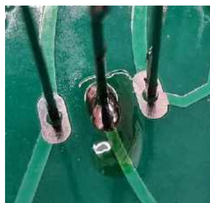
Fotografia 11. W celach estetycznego zamontowania diod do płytki, w pierwszej kolejności przylutuj wyłącznie centralne wyprowadzenia diod LED. Następnie, w razie potrzeby, dokonaj korekty montażu każdej z diod LED zgodnie z opisem w tekście powyżej. Dopiero gdy masz pewność, że każda z diod LED została należyście wyrównana i unieruchomiona w płytce, przylutuj pozostałe wyprowadzenia
