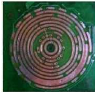
Konstrukcja przełącznika obrotowego (© 2024 Jos Verstraten)
