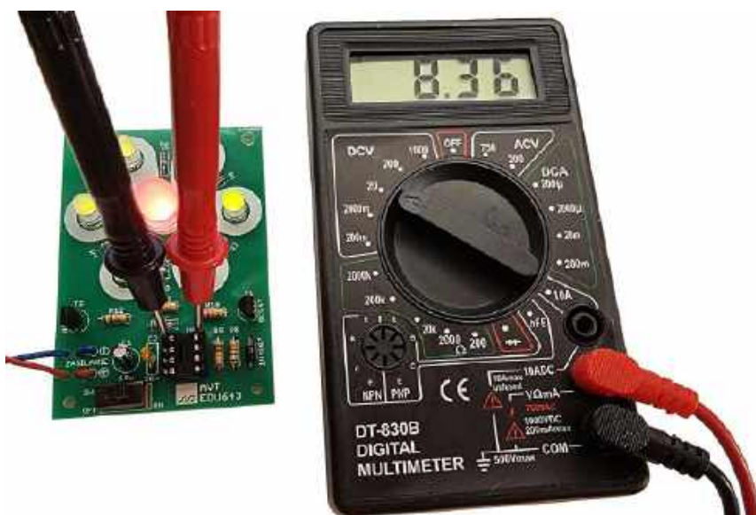
Fotografia 17. Pomiar na zaciskach 8 („plus”) i 1 („minus”) podstawki pod układ NE555 wykazał poprawne napięcie baterii (bez znaku „-”, który sugerowałby błędną polaryzację). Można odłączyć zasilanie i zamontować układ scalony w podstawie
