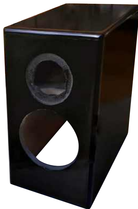
Fotografia 5. Zagruntowane obudowy schną przed klimatyzatorem. Zostały później przeszlifowane na gładko przed nałożeniem podkładu w sprayu, a następnie przeszlifowane ponownie przed nałożeniem warstwy wierzchniej
