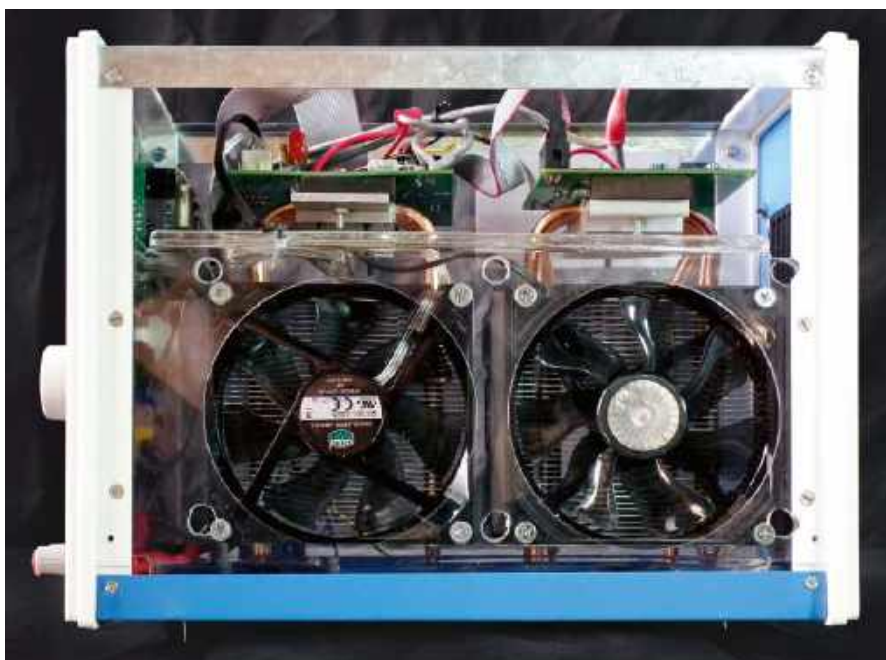
Zdjęcie pokazuje, w jaki sposób płytki PCB należy zamontować na chłodzeniach procesora, chłodzenia należy zamontować do niestandardowego panelu bocznego za pośrednictwem wentylatorów, a panel boczny jest montowany do szyn obudowy
