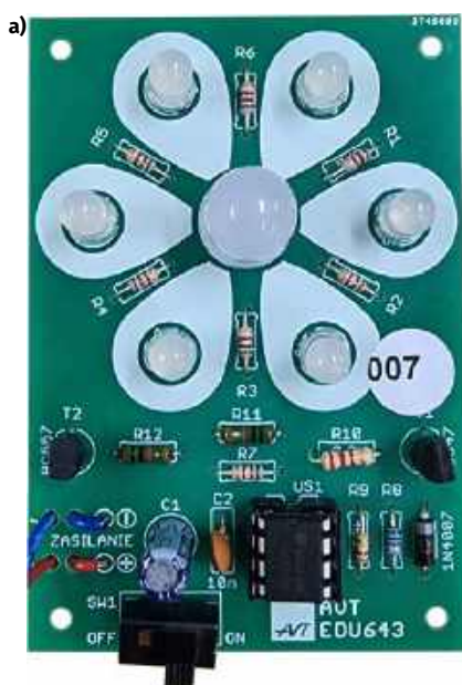
Fotografia 19. Poprawnie zmontowany układ Dwukolorowego kwiatka LED. Widok płytki a) od strony komponentów, b) od strony lutowania
