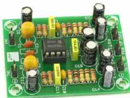
AVT1023 Przedwzmacniacz gramofonowy o charakterystyce RIAA https://sklep.avt.pl/avt1023.html
