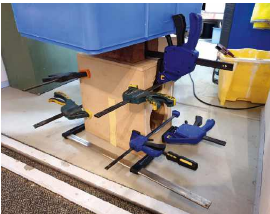
Fotografia 4. Jedna obudowa aktywnego głośnika monitorującego, sklejona i zaciśnięta, czekająca na wyschnięcie. Obudowa leżała przez 24 godziny zanim podjęto dalsze prace
