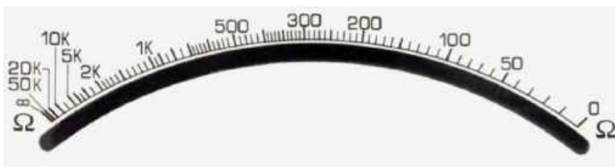
Typowy wygląd skali do pomiaru rezystancji (© 2024 Jos Verstraten)
