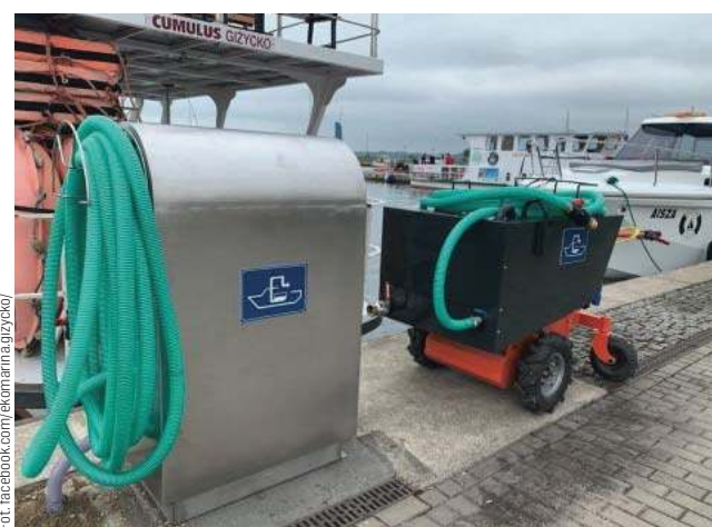
Opróżnienie zbiornika o poj. 200 litrów trwa niecałą minutę
