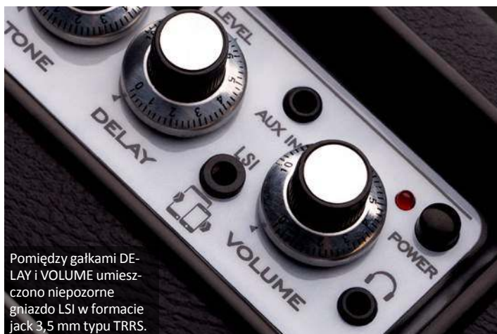
Na niewielkim panelu sterującym znajdziemy zestaw podstawowych regulatorów, wśród których uwagę zwracają dwa potencjometry do obsługi efektu delay.
