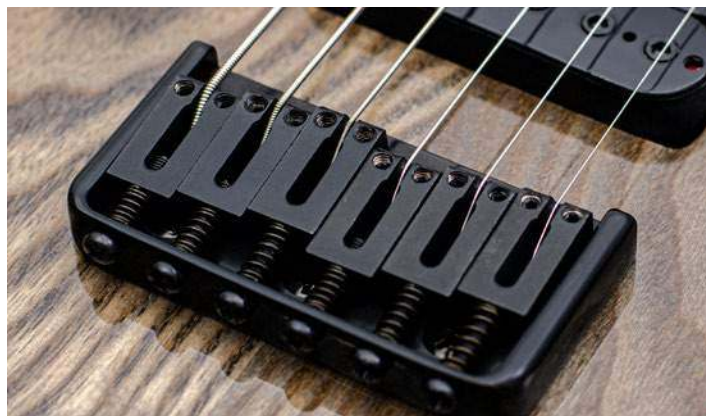
Struny przechodzą przez korpus i stały mostek z odlewanej podstawą i blokowymi siódekami, z klasyczną regulacją wysokości i korekcją menzury dla każdego z siódek.
