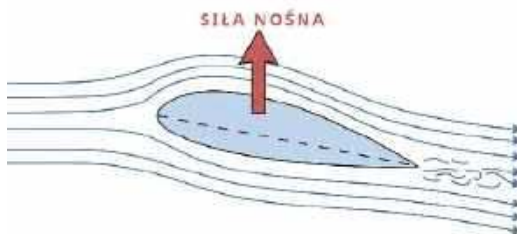
Rysunek 2. Profil skrzydła samolotu i opływające go strugi powietrza
