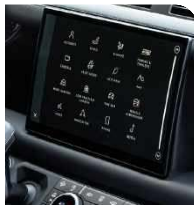
Obrazowanie na dużym dotykowym ekranie pomaga w trybie holowania oraz podczas manewrów Defenderem bez podpiętej przyczepy
