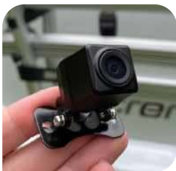
Tylna kamera może być montowana wewnątrz (np. na suficie lub szybie w aucie osobowym), ale też na zewnątrz. Jest oczywiście odporna na warunki atmosferyczne. My na potrzeby testu zamontowaliśmy ją na nieużywanym bagażniku rowerowym
