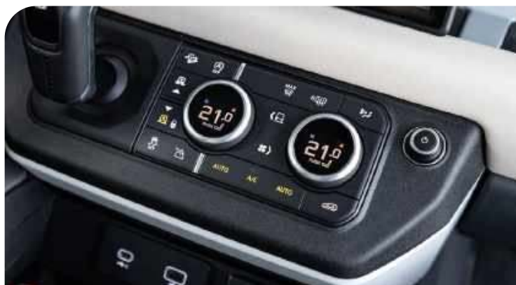
Po wybraniu zaawansowanego asystenta holowania panel z pokrętlami klimatyzacji zamienia się w centrum sterowania cofaniem przyczepy; pokrętło zastępuje kierownicę
