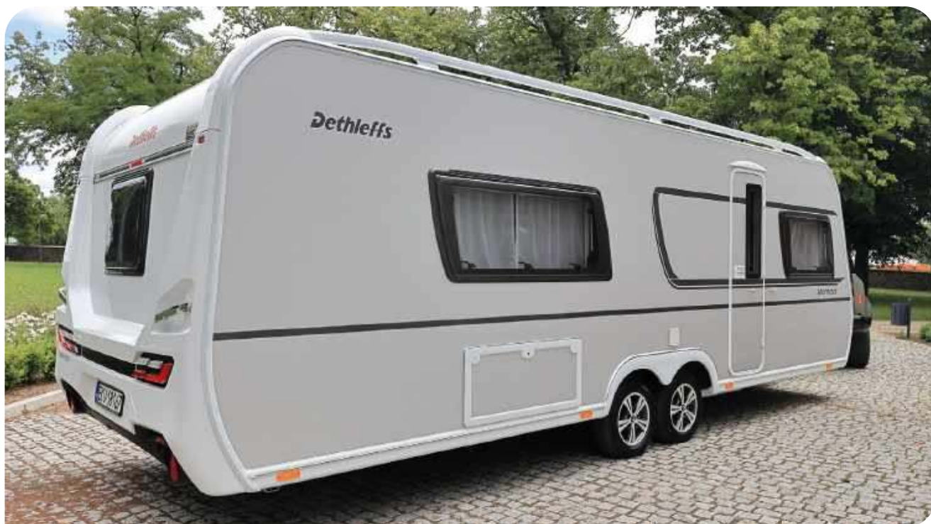
Nomad to przyczepa duża, o DMC 2000 kg; dzięki zawieszeniu dwuosiowemu na drodze zachowuje się stabilnie
