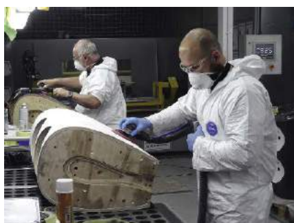
Szlifowanie przed lakierowaniem – liczba zabiegów stolarskich i ręcznej roboty tłumaczy w dużym stopniu koszty i cenę...
