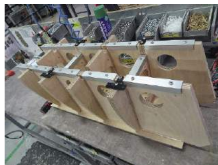
Wewnętrzne wzmocnienie tworzą szkielet wykonany ze sklejk i wzmocniony aluminium profilami.
