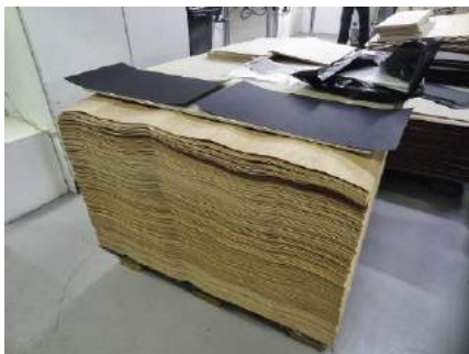
Podstawowym tworzywem obudów serii 800 jest sklejką, którą Bowers produkuje sam z pojedynczych warstw obłogów.
