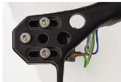
Sposobem Regi wkładka mocowana jest za pomocą trzech (a nie dwóch) śrub.
