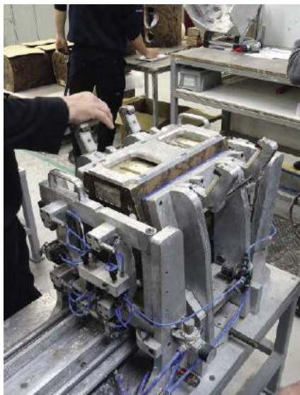
Obudowa najmniejszej 805-ki jest precyzyjnie składana na specjalnym stanowisku.
