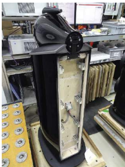
Wydzieloną komorę z tyłu obudowy zajmie zwrotnica zainstalowana do aluminiowego panelu.
