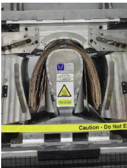
Wielka prasa wygina na „kopycie” odpowiednią liczbę warstw (zależną od modelu) i jednocześnie skleja je w wysokiej temperaturze.
