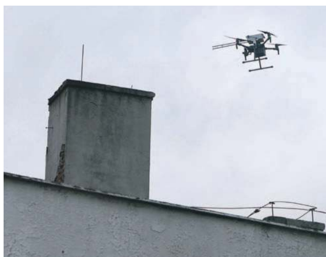
Dron wyposażony jest w stację analizy powietrza i w ciągu kilku sekund wykazuje skład spalin wydobywających się z komina
