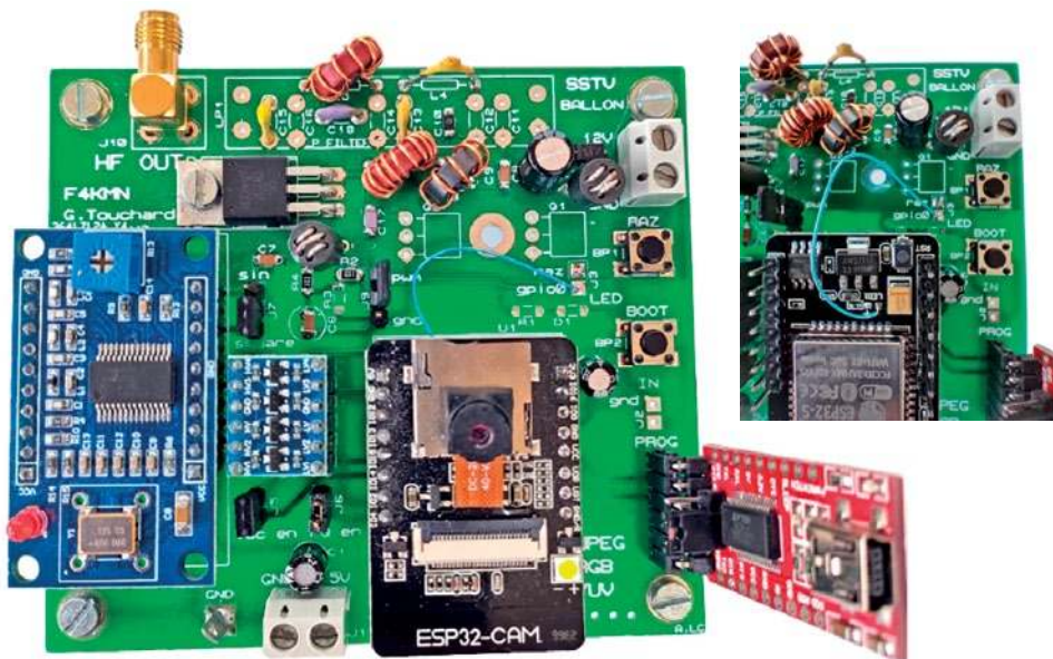
Widok nadajnika. Syntezator znajduje się na niebieskiej płytce po lewej stronie, a układ programatora dla ESP32 – na pionowej płytce po prawej. Powyżej modułu ESP32CAM widoczne jest połączenie (wykonane niebieskim przewodem) pozwalające na regulację wzmocnienia stopnia mocy
