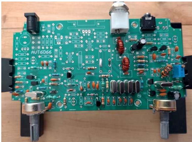
Uruchomiona przez Łukasza SP8LBR część odbiorcza TRX Ewa
