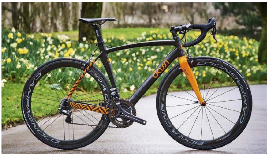
5. Rower Dassi Interceptor z ramą z kompozytów wzmocnianych grafenem
