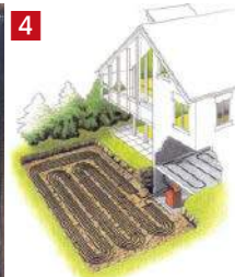
1. Maszyna Perkinsa; 2. Nicolas Carnot; 3. Model instalacji Piccarda w szwajcarskim Bex; 4. Instalacja współczesnego układu gruntowego wymiennika dla pompy ciepła
