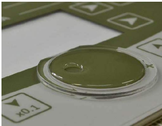
Fotografia 17. Pokrętko magnetyczne zintegrowane z panelem czołowym ( https://bit.ly/3nPNmpN )
