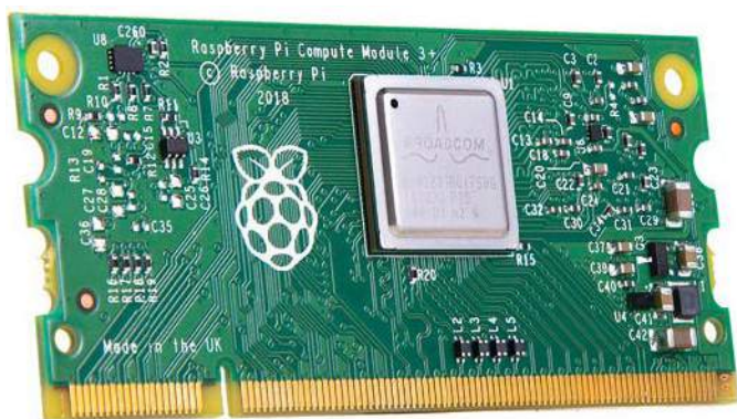
Fotografia 8. Minikomputer Raspberry Pi CM3+ z widocznym złączem krawędziowym
