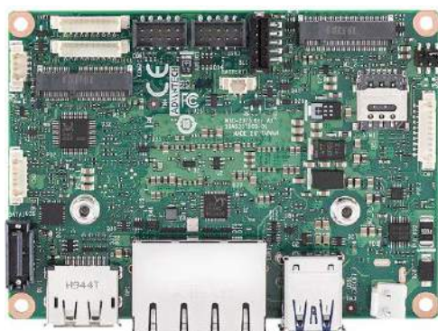
Fotografia 1. Komputer jednopłytkowy typu MIO-2375
