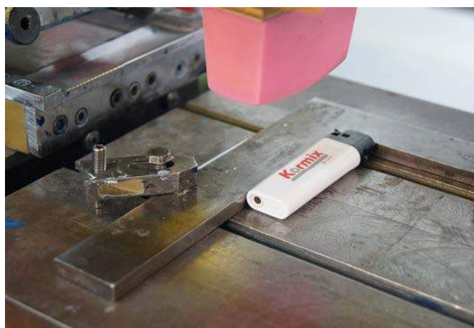
Fotografia 9. Kolorowy tampodruk na powierzchni tworzywowej zbiornika zapalniczki. Widoczny silikonowy stempel, służący do przenoszenia farby – górny element. ( https://bit.ly/3IG8V9L )
