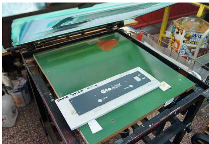
Fotografia 8. Prosty nadruk monochromatyczny na panelu czołowym, wykonany metodą sitodruku ( https://bit.ly/3IG8V9L )
