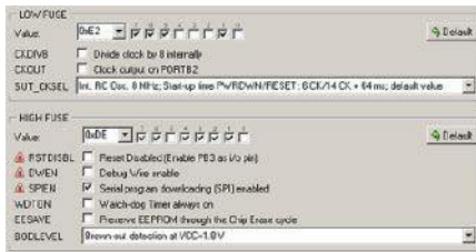
Rysunek 4. Konfiguracja bitów zabezpieczających w programie BitBurner
