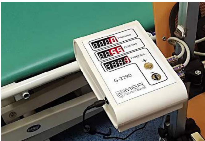
Fotografia 11. Panel czołowy wykonany na bazie czarno-białego laminatu grawerskiego
