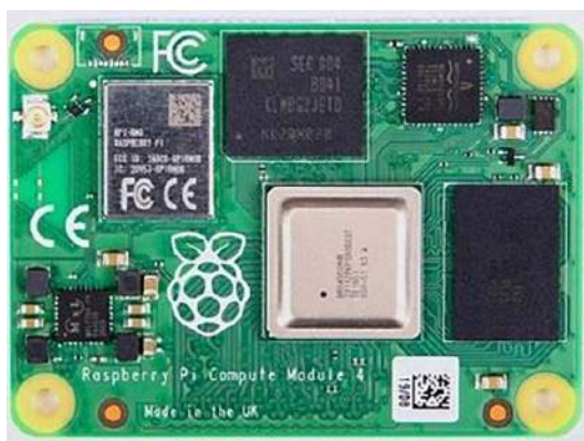
Fotografia 9. Minikomputer Raspberry Pi CM4 – widok z góry
