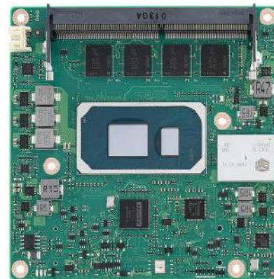
Fotografia 5. Komputer jednopłytkowy typu SOM-6883
