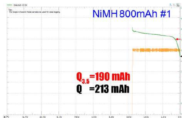
Rysunek 9. Wyniki pomiaru rzeczywistej pojemności akumulatora Ni-MH 800 mAh #1 – wykazującego duży stopień zużycia
