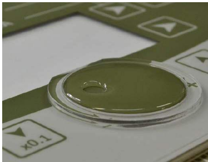
Fotografia 17. Pokrętło magnetyczne zintegrowane z panelem czołowym ( https://bit.ly/3nPNmpN )
