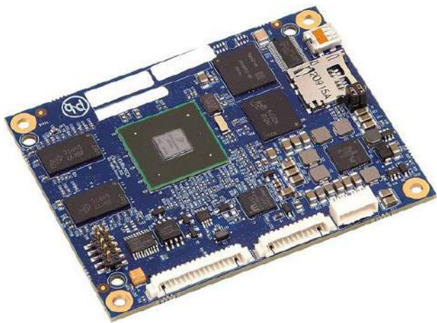
Fotografia 3. Energooszczędny minikomputer SBC CPU-301-16 marki Eurotech
