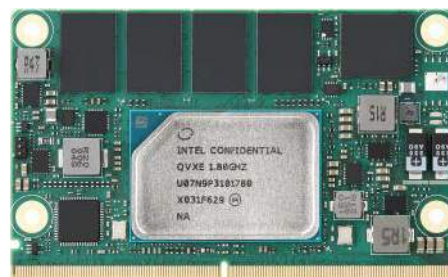
Fotografia 6. Komputer jednopłytkowy typu SOM-2532
