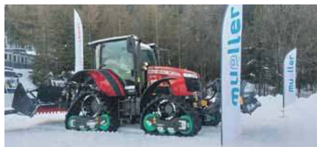
Taka maszyna zimą może służyć do wytyczania tras, odśnieżania i innych prac komunalnych, a latem pracować jako zwykły ciągnik, do którego podłączymy zamiataarkę czy kosiarkę - mówi prezes firmy Tracktech Bogusław Pokrywa.
