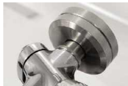
Przeciwwagę nasuwamy tylko na tylny trzpień.
