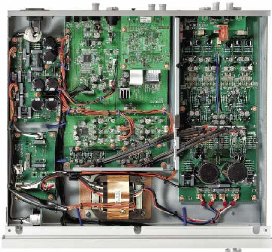
Niezależnie od oryginalnych układów DAC, chlubę przynosi rozwinięte zasilanie i separacja poszczególnych modułów.
