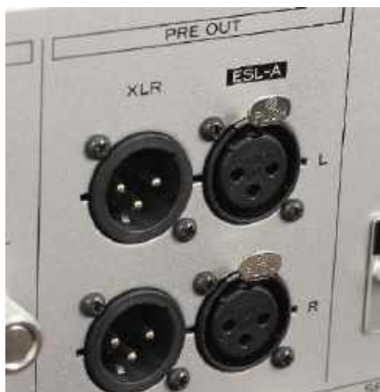
Wyjścia (z przedwzmacniacza) są dwa, każde w formie XLR, ale z obsługą sygnałów różnego typu (jedno dla sygnałów typu ESL-A).
