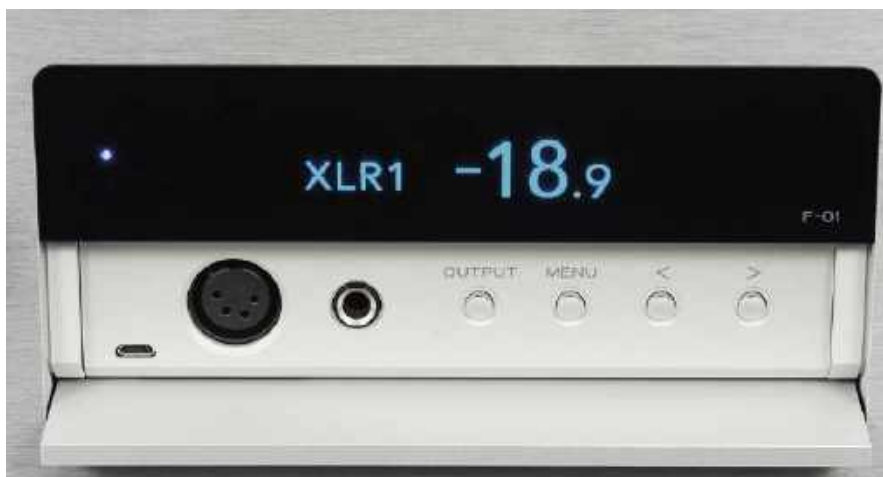
Po uchynieniu klapki mamy dostęp do menu i wyjść słuchawkowych.
