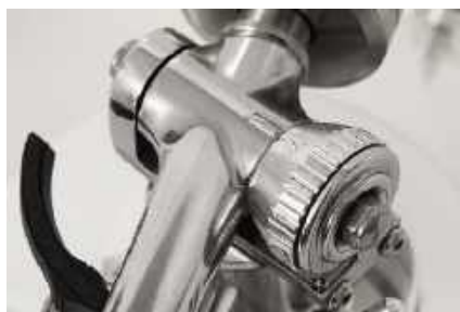
Do regulacji siły nacisku igły służy precyzyjne pokrętło.
