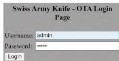
Zrzut ekranu 3. Strona logowania Over The Air (OTA), wyświetlana przy pierwszym dostępie przez przeglądarkę do ESP32
