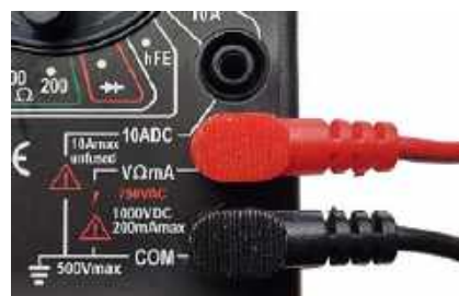
Fotografia 20. Poprawne podłączenie kabli na przykładzie multimetru DT-830B, ustawionego na funkcję woltomierza napięć statycznych
