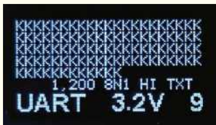
Zrzut 16: Dekoder transmisji szeregowej UART bywa niezastąpiony. Jest on, podobnie jak tryb oscyloskopu, dalece konfigurowalny pod względem szybkości transmisji, ilości bitów i aktywnego stanu logicznego. Tu widzimy działanie w trybie tekstowym
