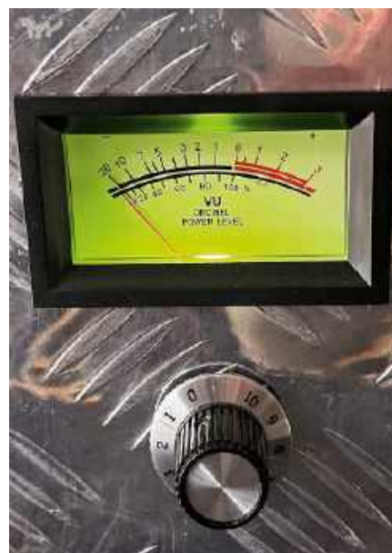
Fotografia 2. Wskaźnik wystereowania jest przydatny do sprawdzenia z jaką mocą jest wystereowany wzmacniacz, dlatego musi być skalibrowany dla konkretnej impedancji obciążenia
