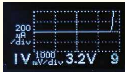
Zrzut 18: W trybie pomiaru diod nie są wykrywane diody podwójnie połączone antyrównolegle, np. LED-y dwukolorowe. Natomiast charakterograf bada elementy przy obu polaryzacjach. Skale napięcia i prądu można powiększyć, uzyskując więcej szczegółów
