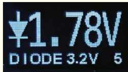
Zrzut 24. W trybie pomiaru diody wyświetlacz jest podobny jak w trybie automatycznym, ale prąd testowy płynie tylko w jednym kierunku: od CON+ do CON-. Umożliwia to szybkie wykrywanie polaryzacji i ogólne sprawdzanie diod LED
