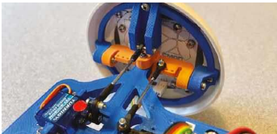
Rysunek 9. Dwa serwomechanizmy sterujące okiem SMAD-a. Zdjęcie: Steve Manley
