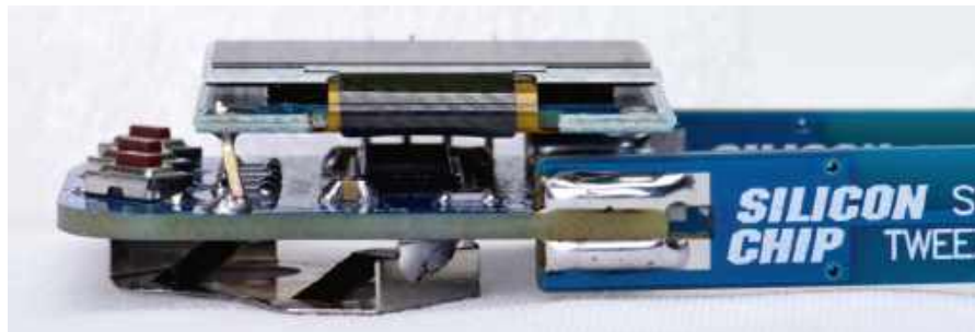
Na zdjęciu widać odstęp między modułem wyświetlacza a główną płytką drukowaną. Zwróćmy uwagę na pin w rogu wyświetlacza, pochodzący ze złącza męskiego „goldpin”, a użyty jako element dystansowy i wzmacniający. Zapobiega on wyginaniu się płytek względem siebie i powstawaniu zwarc między nimi
