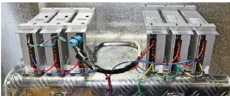
Fotografia 3. Połączenie szeregowo sześciu zasilaczy i okablowanie sieciowe. Należy zauważyć, że na tym początkowym etapie nie użyliśmy złączy zaciskanych. Nie są one bezwzględnie konieczne, ale jeśli są prawidłowo zaciśnięte, zapewniają bezpieczniejsze mocowanie i mniejsze ryzyko przypadkowych zwarc. Nie oszczędzaj na opaskach kablowych po zakończeniu okablowania, zwłaszcza na wiązkach przewodów sieciowych
