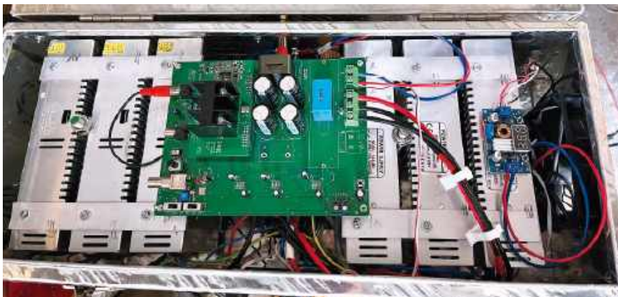
Fotografia 9. Zasilacz impulsowy ładnie mieszczą się w aluminiowej skrzynce narzędziowej, a kilowatowy wzmacniacz zamontowany na plastikowych izolatorach zajmuje niewielką powierzchnię w górnej części. Mały moduł po prawej stronie zapewnia napięcie 12 V z wyjścia 24 V...25 V dowolnego zasilacza impulsowego, do zasilania wentylatora 12 V DC i podświetlenia wskaźnika wysterowania
