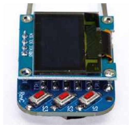
Dzięki trzem przyciskom kalibracja i przełączanie trybów są znacznie łatwiejsze niż w poprzednich wersjach pęsety
