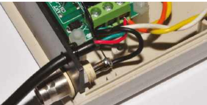
Rysunek 6. Na rysunku widoczny jest kabel zasilający (u góry) i złącze antenowe BNC (u dołu). Oryginalna antena została skrócona i jej ucięty koniec został przylutowany do środkowego styku złącza BNC. Użycie anteny zewnętrznej znacznie zwiększa zasięg działania systemu
