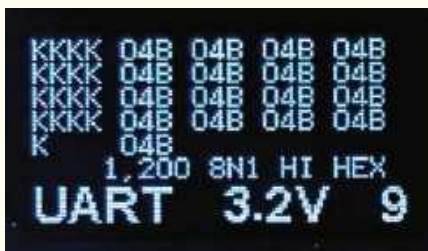
Zrzut 17: Dekoder transmisji szeregowej ma również tryb szesnastkowy, przydatny do wyświetlania danych binarnych i kodów sterujących. Pokazywane są błędy ramki i parzystości, co pomaga w określeniu właściwego formatu danych
