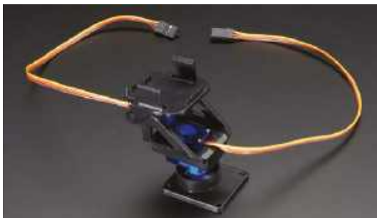
Rysunek 8. Tradycyjna implementacja zespołu obrotu i pochylania. Oba ruchy są izolowane mechanicznie
