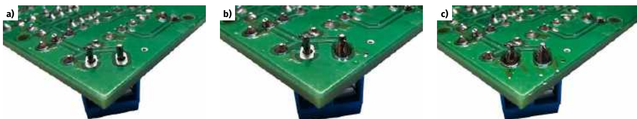
Fotografia 16. Poprawny montaż złączy śrubowych dla mikrofonów: a) włóż złącze do płytki tak, aby otwory do montażu mikrofonu skierowane były na zewnątrz urządzenia; b) przylutuj jedno z wyprowadzeń i upewnij się, czy złącze dobrze przylega do płytki; c) gdy wszystko jest w porządku, przylutuj drugie wyprowadzenie
