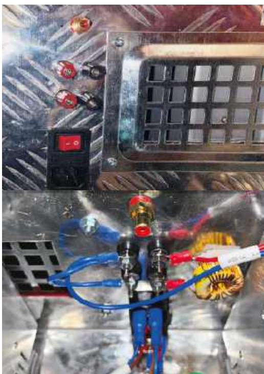
Fotografia 4. Tylne panel wzmacniacza, ze złączem wejściowym na górze, zaciskami wyjściowymi 2 \Omega ...4 \Omega poniżej i zaciskami wyjściowymi 8 \Omega tuż nad przetaczanym i zabezpieczanym gniazdem wejściowym. Wentylator, którego używaliśmy, został wycofany, więc zastosowaliśmy nieco mniejszy. Należy również zauważyć, że gniazdo wejściowe RCA zostało przesunięte w dół, ponieważ mieliśmy problemy z pokrywą uderzającą w prototyp
