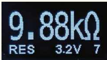
Zrzut 22. W trybie pomiaru rezystancji otrzymujemy te same wyniki, co w trybie Auto, ale pisane większą czcionką, co bardzo ułatwia sprawdzanie i sortowanie rezystorów
