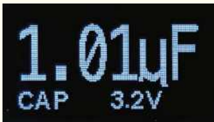
Zrzut 23. Tryb pomiaru pojemności działa podobnie, wyświetlając wyjątkowo pojemność, za to w dużym rozmiarze. Jest idealny do sprawdzenia który element jest który w sterce kondensatorów SMD pozbawionych oznaczeń
