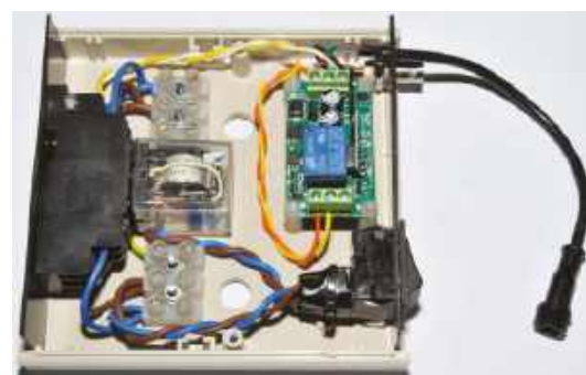
Rysunek 2. W systemie zdalnego sterowania o dużym zasięgu wykorzystany został niedrogi moduł odbiornika, przekaźnik sieciowy i kilka dodatkowych elementów, takich jak listwy połączeniowe, przełącznik do ręcznego sterowania oświetleniem oraz złącze do anteny zewnętrznej. Do zasilania odbiornika wykorzystany został kabel z fabrycznie zaprawionym przyłączem sieciowym
