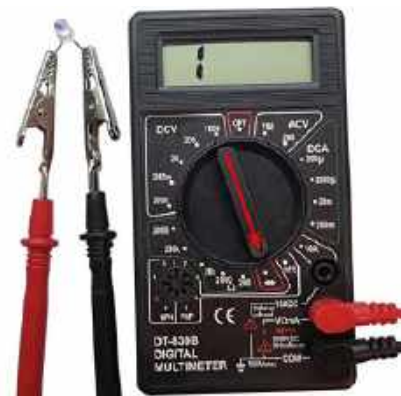
Fotografia 14. Sprawdzanie diody LED za pomocą multimetru ustawionego funkcję testowania diod. Po przyłożeniu sondy czerwonej do anody, a czarnej do katody, sprawna dioda LED powinna się zaświecić. Jeśli dioda ma odpowiednio długie (jeszcze nie przycięte) wyprowadzenia można się wspomóc krokodylkami
