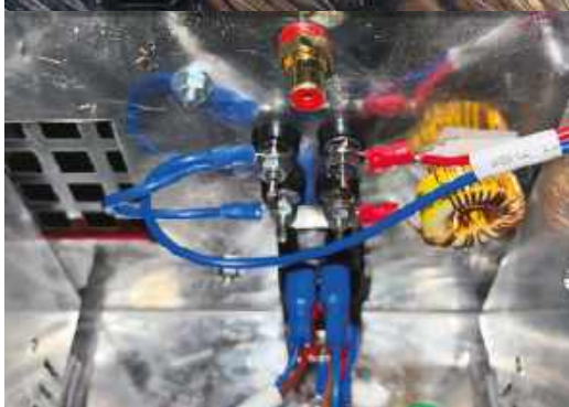
Fotografia 5. Wnętrze tylnej części obudowy. Wejście audio to podwójne gniazdo RCA montowane w obudowie, natomiast złącza wyjściowe to zaciski. Dolne wyjście dla obciążeń 8 \Omega ma dodatkowy dławik 75 \mu\text{H} , aby zapobiec skokowi w górnej części pasma przenoszenia, który mógłby uszkodzić głośniki wysokotonowe
