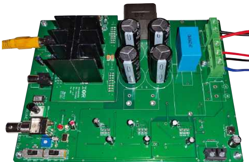
Fotografia 1. Płytkę ewaluacyjną IRAUDAMP9 z układem scalonym wzmacniacza klasy D (pod dużym radiatorze) i układami pomocniczymi. Jedynymi wymaganymi połączeniami są: wejście sygnału w lewym górnym rogu, wyjście głośnikowe w prawym górnym rogu i złącze zasilania. Poniżej znajdują się wejścia szyny zasilającej \pm 72 V...75 V DC. Jeśli używasz wskaźnika wystereowania, prawdopodobnie połączysz również jego przewody sygnałowe do dwudrożnego terminala głośnikowego
