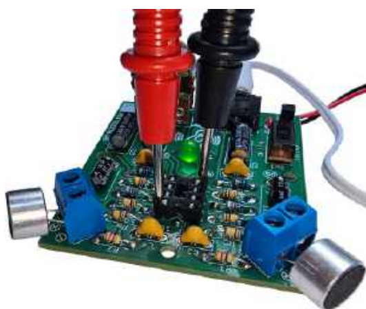
Fotografia 21. Pomiar na zaciskach 8 („plus”) i 4 („minus”) podstawki pod układ NE5532 wskazał poprawne napięcie baterii (bez znaku „-”, który sugerowałby błędną polaryzację). Można teraz odłączyć zasilanie i zamontować układ NE5532 w podstawce
