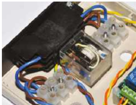
Rysunek 4. Na rysunku widoczne są listwy elektryczne z zaciskami śrubowymi dla potężnej wejścia i wyjścia zasilania sieciowego oraz odpowiednie otwory dla kabli. Te listwy ułatwiają podłączanie odbiornika w warunkach terenowych
