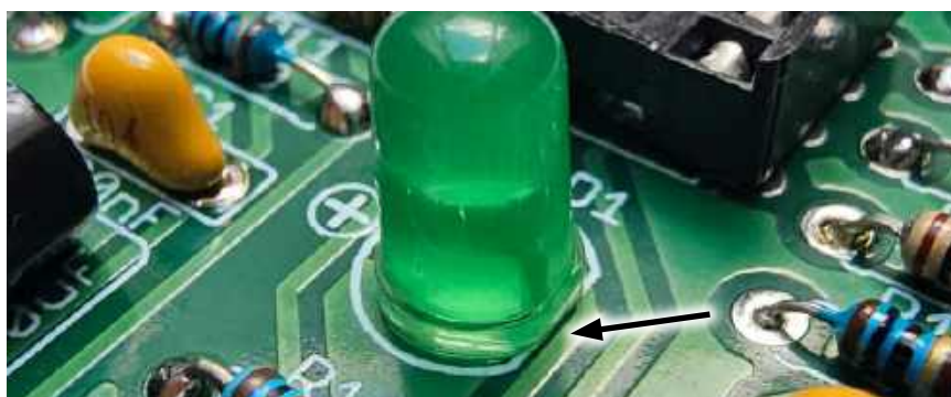
Fotografia 13. Poprawnie zamontowana dioda LED. Płaskie ścięcie na obwodzie podstawy diody LED, symbolizujące katodę, musi pokrywać się z fragmentem linii prostej w obrysie komponentu widocznym na płytce
