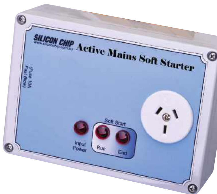
Gotowy układ aktywnego „miękkiego startu”. Jest łatwy w użyciu. Wystarczy wpiąć urządzenie zewnętrzne do gniazda na panelu przednim, a złącze IEC z boku układu dotaczyć do sieci energetycznej
