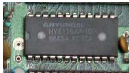
Układ pamięci SRAM o pojemności 2 KB używany w klonie NES. Pamięć SRAM jest znacznie szybsza, ale droższa niż DRAM, więc jest stosowana w małych objętościach, tak jak w pamięciach podręcznych L1 i L2 (od kilku KB do kilku Mb). Źródło: https://www.wiki/63EN
