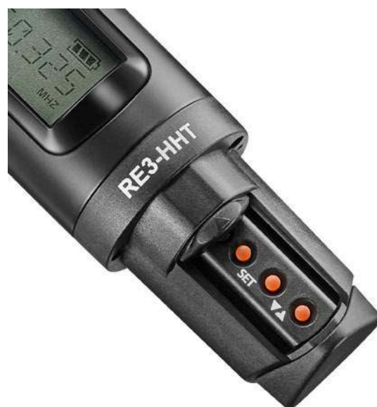
W obudowie anteny nadawczej schowane pod przesuwaną klapką są trzy przyciski, pozwalające na dokonywanie zmian w ustawieniach nadajnika.
