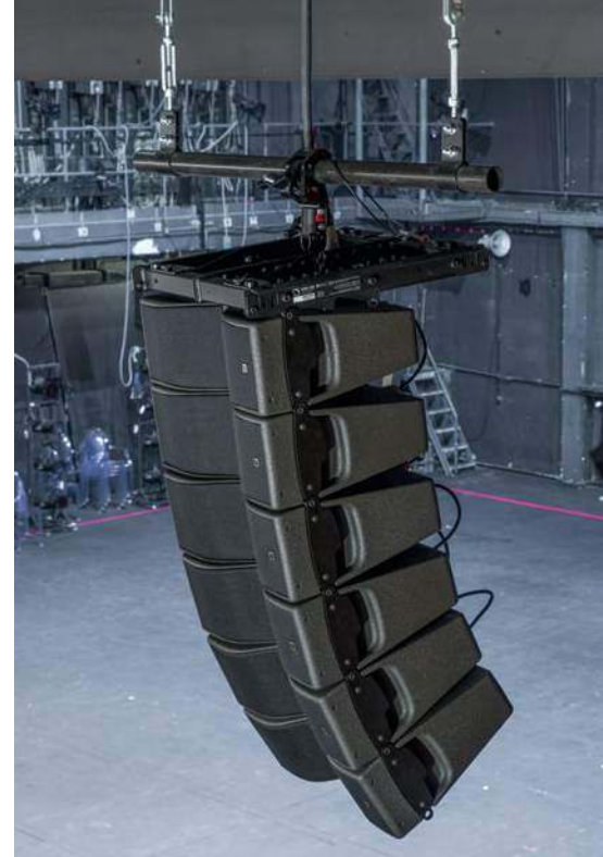
System frontowy opiera się na produktach L-Acoustics, a konkretnie modułach Kiva II, których w sumie dostarczono 12.
