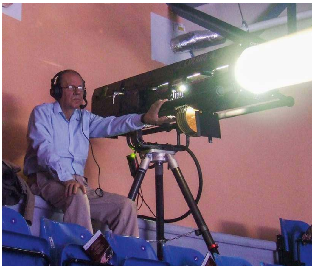
Followspot „nie istnieje” bez operatora, który ręcznie kieruje światło wydobywające się z followspota w stronę oświetlanego obiektu.
