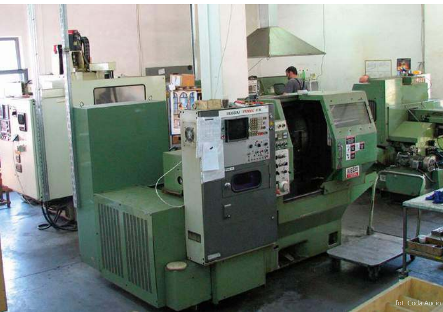
Hardware do podwieszania systemów wykonywany jest z wykorzystaniem precyzyjnych obrabiarek CNC, również we własnej fabryce...
