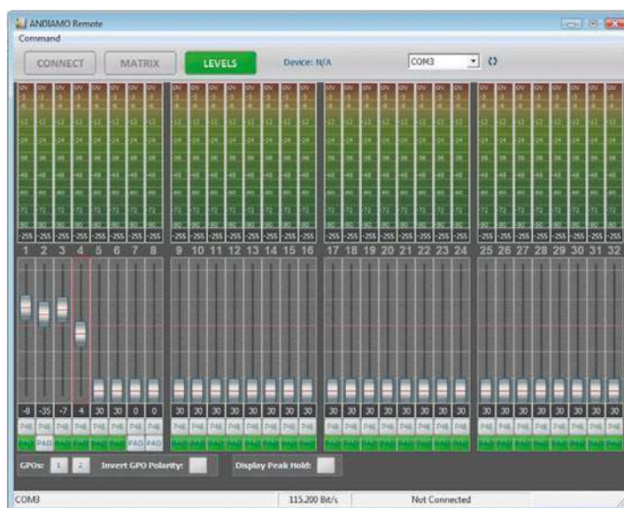
Oprogramowanie sterujące ANDIAMO Remote pozwala m.in. na szybki dostęp do regulacji wzmocnienia (czułości) oraz załączania zasilania Phantom i PAD-a indywidualnie dla każdego z 32 preampów.
