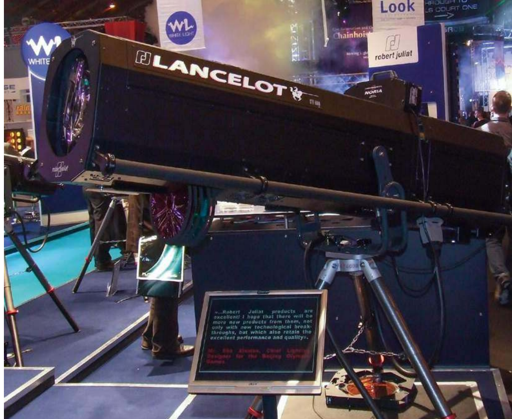
Reflektory prowadzące są dość długie, ponieważ wymaga tego optyka.
