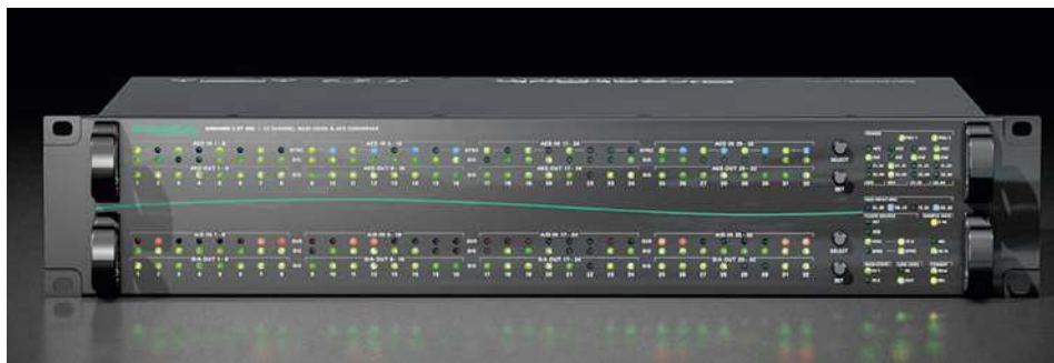
Podobnie jak ANDIAMO.MC, ANDIAMO 2.XT SRC dysponuje odpowiednim do liczby kanałów zestawem kontrolerek, informujących o obecności sygnału na wejłwiy cyfrowych i analogowych, synchronizacji AES i przesterowaniu wejść analogowych.
