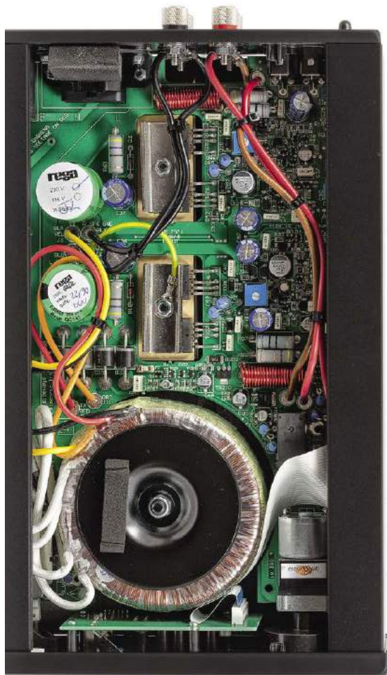
W małej obudowie „spakowano” solidny wzmacniacz. Jedną z konsekwencji kompaktowej formy jest jej nagrzewanie.
