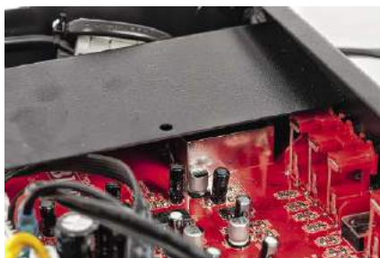
Również sekcję przedwzmacniacza gramofonowego starannie zaekranowano.
