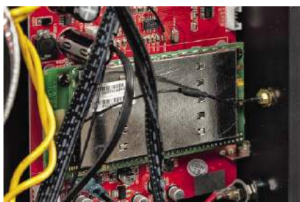
Moduł funkcji strumieniowych dostarczyła firma Frontier Smart Technologies
