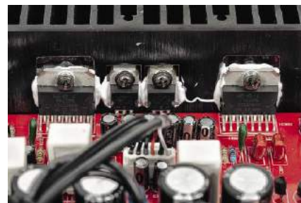
Końcówki mocy oparto na układach scalonych TDA7246 STMicroelectronics.
