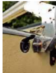
Po lewej stronie na burcie znajdziemy gniazdo zewnętrznej anteny TV, po prawej gniazdo zapalniczki do zasilania oświetlenia markizy lub dowolnego urządzenia
