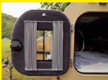
Drzwi to przykład dopasowania i elegancji; odsuwana szybka wraz z wentylatorami i wentylatorem zapewni cyrkulację powietrza wewnątrz, a zasłony skutecznie obronią przed słońcem
