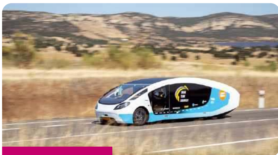
Stella Vita podczas dziewiczej podróży przejechała ponad 2000 km. Podwozie aluminiowe, obudowa z włókna szklanego
