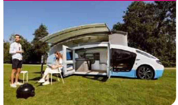
Cały dach pokryty jest panelami słonecznymi. Po jego rozłożeniu na postoju powierzchnia paneli słonecznych zwiększa się dwukrotnie – do 17,5 m 2
