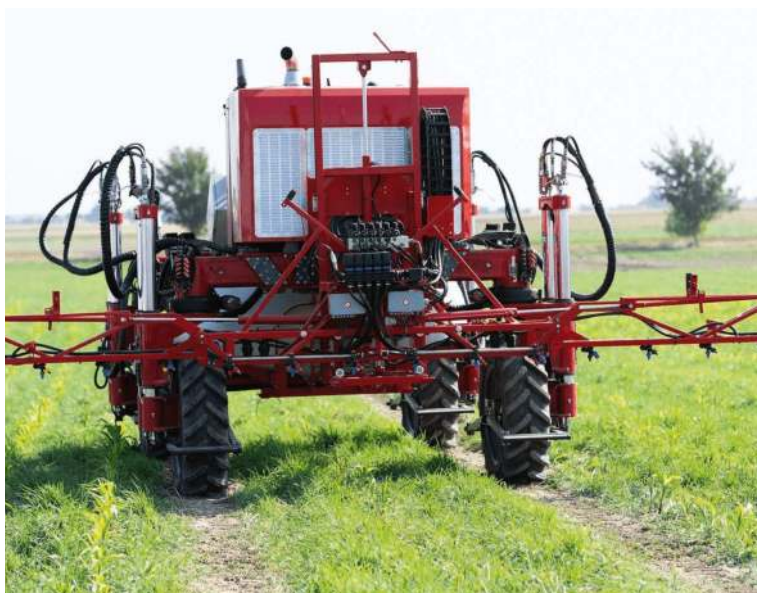
Polski Robot niebawem pojawi się na rynku. Sam siewie, pili, prowadzi opryski i doszuje środki ochrony roślin oraz nawozy. Rozpoznaje rośliny i tworzy mapę pól.
