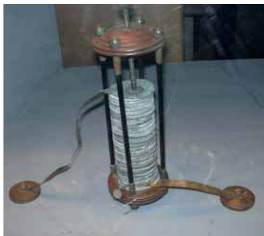
Ryc. 4a) Oryginalne ogniwo Volty z Muzeum w Como: stosik par krążków cynkowych i miedzianych, przelozonych filcem zwilżonym kwasem. b) To samo muzeum – dwa ogniwa „stosy” i bateria szklanek, połączonych elektrycznie (płytki cynkowe i miedziane). Foto: GK; Tempio Voltiano, Como.
