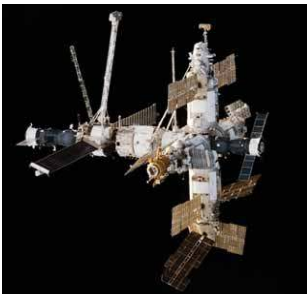
Stacja orbitalna Mir, budowana przez ZSRR od 1986 r. Przy końcu rozbudowy Mira, stacja miała masę ponad 135 ton i miała 31 m szerokości oraz 33 m długości.
