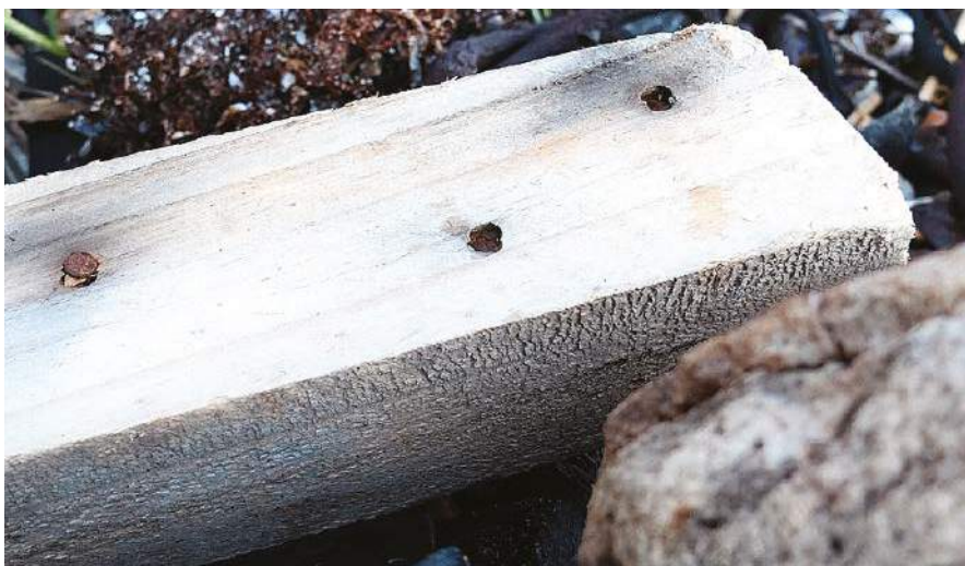
Fotografia 2. Magnetometr nie miał problemu z wykryciem z dość dużej odległości trzech żelaznych gwoździ znajdujących się wewnątrz drewna ukrytego w młotwie rupieci
