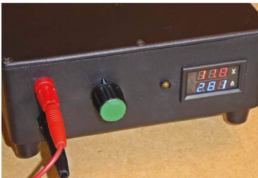
Fotografia 1.9. Zmienne obciążenie testowe może być nieocenione, jeśli często testujesz zasilacze
