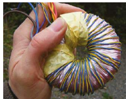
Fotografia 15. Sporadyczne, dodatkowe uzwojenie może być dodane do transformatora toroidalnego, aby uzyskać dodatkowe „wolne” zasilanie niskim napięciem. Jest to trochę pracochłonne, ale bywa interesujące
