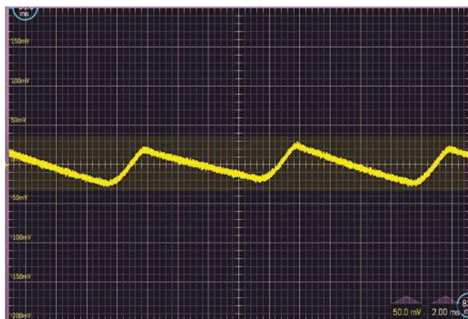
Rysunek 1.7. Tętnienia obecne na wyjściu drogiego zasilacza liniowego. Tętnienia występują przy częstotliwości 100 Hz (dwukrotność częstotliwości sieci zasilającej) i mają amplitudę 50 mV
