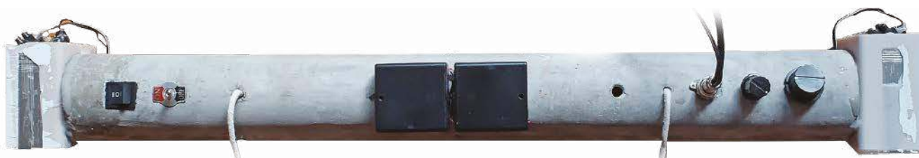
Fotografia 1. Prototyp magnetometru, zamontowany wewnątrz betonowej rury. Bardzo sztywna konstrukcja układu, nie zalecamy kopiowania tej metody!
