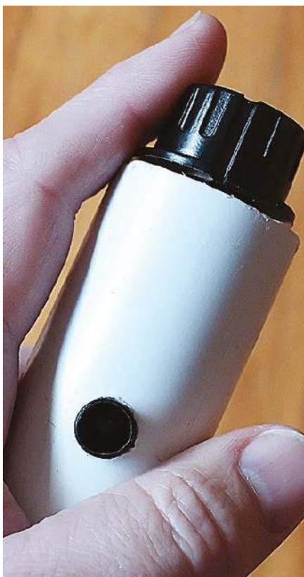
Fotografia 5. Ręczna jednostka sterująca ma potencjometr regulacji czułości (VR4) i wskaźnik (LED3). Ta część jest wbudowana w odcinek rury PVC
