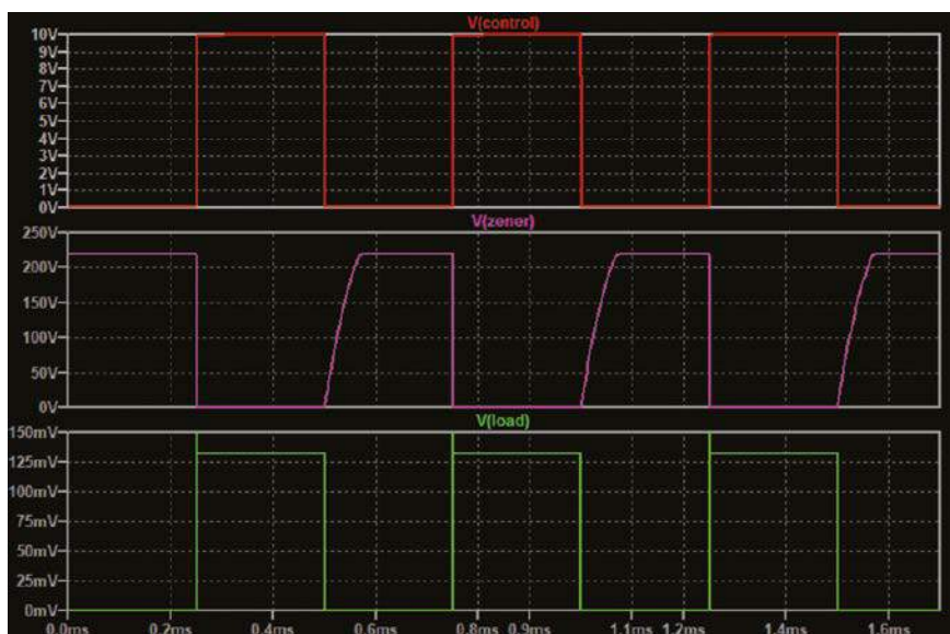
Fotografia 3. Wyniki symulacji dla układu z rysunku 2 – góra: V(sterowanie); środek: V(zener); dół: V(obciążenie)
