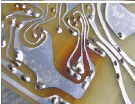
Fotografia 3. Stabilizatory Zenera często rozpraszają wiatr lub dwa. Upewnij się, że płytka nie ugotowała się – umieść rezystory na podstawkach i z dala od kondensatorów elektrolitycznych
