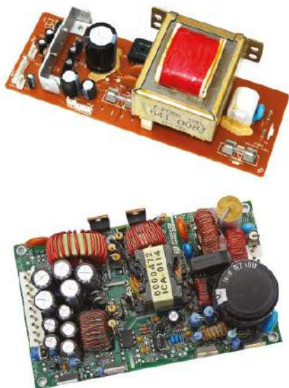
Fotografia 1.2. Powyżej, typowy zasilacz liniowy w porównaniu z (poniżej) zasilaczem impulsowym (SMPS). Oba zasilacze mają wiele wyjść i mają podobne parametry znamionowe, ale nadają się do zupełnie innych zastosowań
