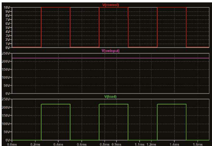
Fotografia 5. Wyniki symulacji dla układu z rysunku 4 – góra: V(sterowanie); środek: V(swinput); dół: V(obciążenie)
