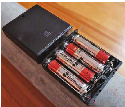
Fotografia 4. Do zasilania użyliśmy ośmiu ogniw alkalicznych, ale pamiętaj, że przy poborze prądu 100–150 mA nie wytrzymają długo! Dziesięć ładowalnych ogniw NiMH lub NiCd może być lepszym rozwiązaniem lub nawet 12 V bateria SLA lub LiPo. Z perspektywy czasu, zastanowilibyśmy się jednak poważnie nad zestawem 4×18650 (14,8 V)
