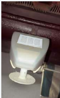
❷ Stacja pogodowa współdziałająca z domową automatyką.
