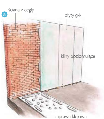
Mocowanie suchego tynku: na klej (a), na pasach z płyt (b), na profilach stalowych (c).
