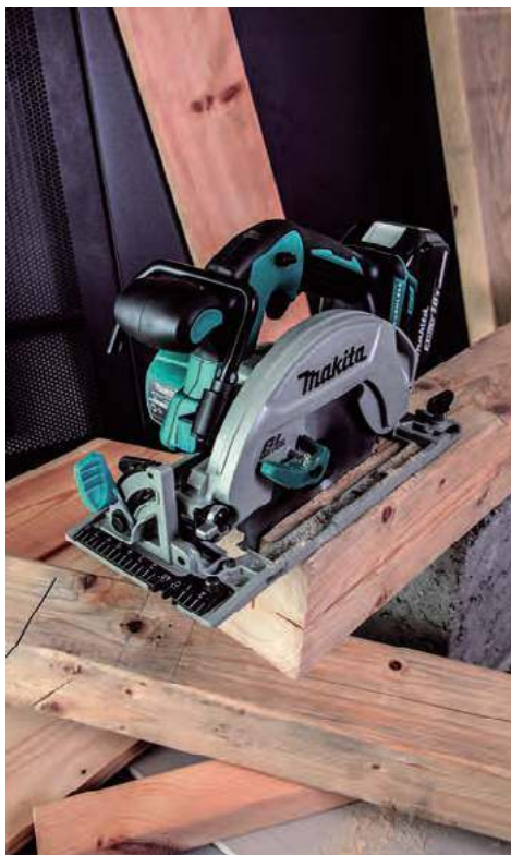
P ilarka tarczowa to bardzo popularny rodzaj piły, służący do przycinania elementów drewnianych oraz drewnopochodnych. MAKITA
