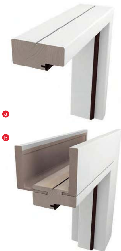
🔧 Ościeżnica stała (a) i regulowana (b). Obecnie sporo ram ma regulowaną szerokość (od 9 do nawet 50 cm), co pozwala na dopasowanie elementu do grubości ściany. POL-SKONE
