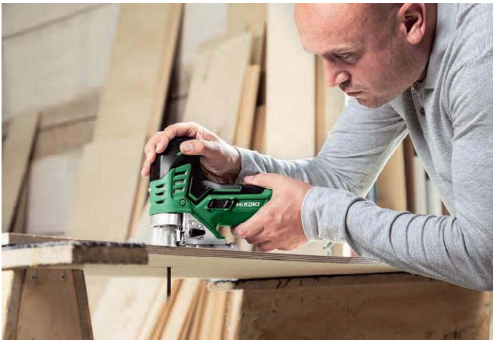
P Wyrzynarki znajdą zastosowanie w warsztacie każdego majsterkowicza. Tego typu urządzenia są szczególnie przydatne, jeśli zależy nam na precyzyjnym wycinaniu elementów dekoracyjnych. HITACHI
