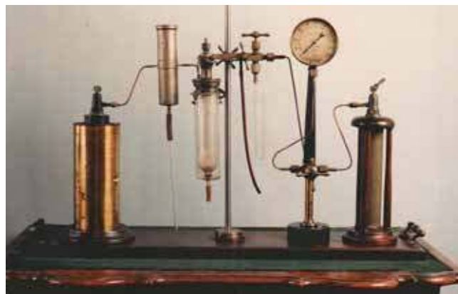
Rys. 11. Przyrząd do pomiaru mechanicznego równoważnika ciepła z eksperymentu Joule'a 1843 r., źródło: Wikipedia.
