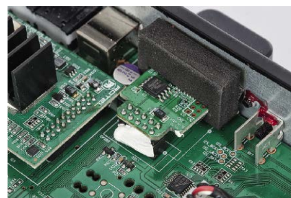
Moduł Bluetooth częściowo (wraz z anteną) wystaje poza obrys obudowy.
