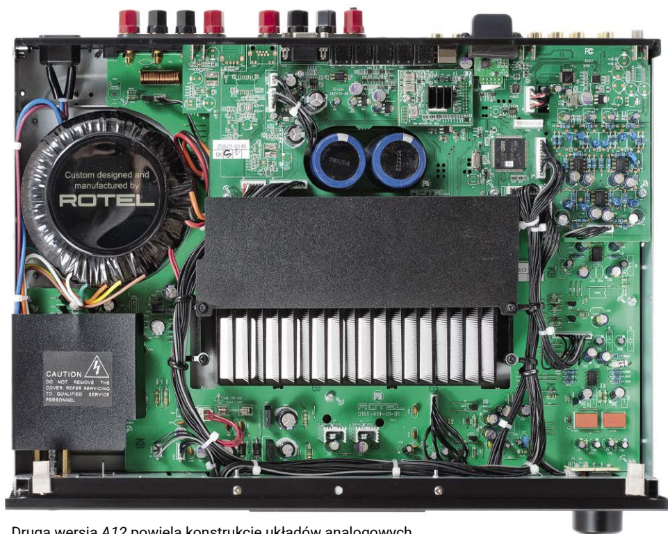
Druga wersja A12 powiela konstrukcję układów analogowych, zmiany skupiają się w sekcji cyfrowej.
