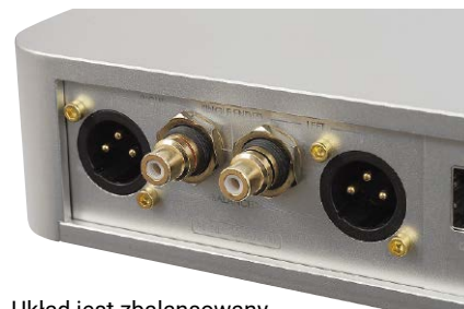
Układ jest zbalansowany już na etapie konwerterów cyfrowo-analogowych.
