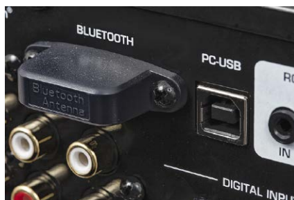
W sekcji cyfrowej najważniejsze jest wejście USB-DAC, ale duże praktyczne znaczenie ma też Bluetooth.
