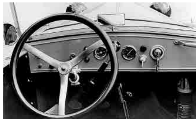
Kabina DKW F-1 była bardzo skromnie wyposażona. Kto jednak jeździł np. Trabantem 601 wie, że „klamka” służąca do zmiany biegów była bardzo wygodna
