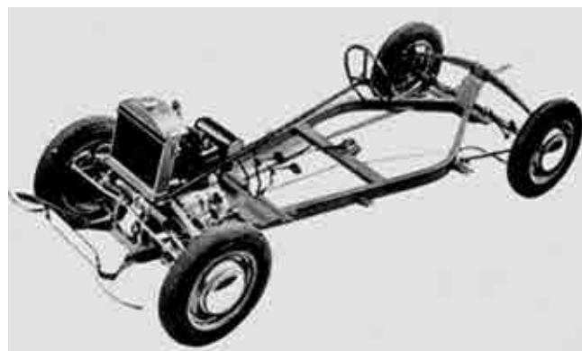
Podwozie DKW F-1 - wzór prostoty. Tą konstrukcją inspirowali się, choć nie wprost, m.in. konstruktorzy SAAB-a 92 czy naszej Syreny
