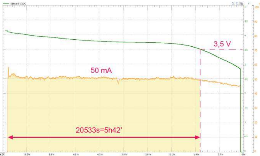
Rysunek 4. Obliczenie użytkowej pojemności akumulatora 320 mAh
