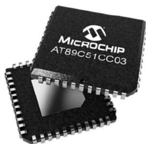
Rysunek 5. Jedna z nowych wersji mikrokontrolera 8051 – układ AT89C51CC03. Może być taktowany sygnałem do 60 MHz i zawiera wiele zaawansowanych układów peryferyjnych, np. kontroler magistrali CAN
