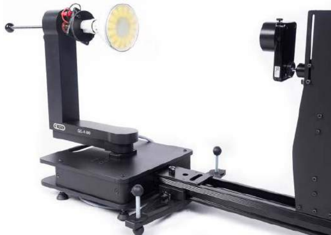
Fotografia 5. Goniografometr wykorzystywany do pomiaru rozkładu przestrzennego światła emitowanego przez lampę
