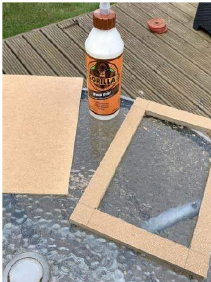
Fotografia 2. Elementy obudowy wykonane z płyty MDF
