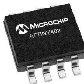
Rysunek 1. Mikrokontroler AVR przeznaczony do zastosowań w branży motoryzacyjnej. Jest wyposażony w małą liczbę wyprowadzeń (8...20), szereg układów czasowo-licznikowych, podstawowe interfejsy komunikacyjne, komparator i przetwornik ADC. Pracuje z zasilaniem 2,7...5,5 V, w temperaturze -40...+125°C
