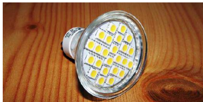
Fotografia 1. Białe diody LED z charakterystycznym żółtym zabarwieniem struktury
