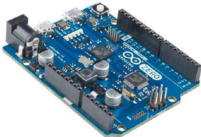
Fotografia 1. W wielu płytkach rodziny Arduino stosowane są mikrokontrolery serii SAM D21, np. Arduino Zero
