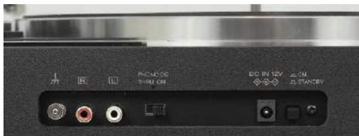
Obok wyjść RCA zainstalowano włącznik przedwzmacniacza korekcyjnego.
