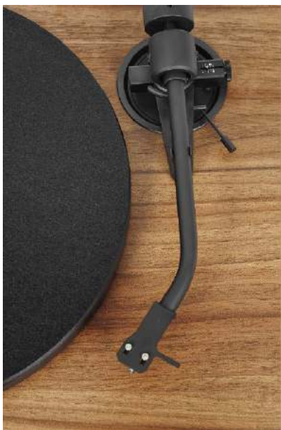
Ramię to konstrukcja o typowej długości 8,6 cala, jednak kryje kilka ciekawostek.
