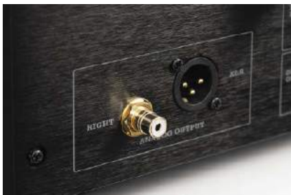
Konstrukcja jest w pełni zbalansowana, a na każdym z wyjść (RCA i XLR) mamy do dyspozycji regulację głośności.
