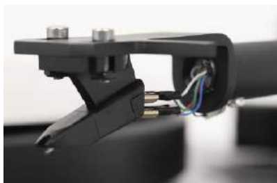
Główka jest zintegrowana z rurką. Wkładka wygląda jak Ortofon z serii OM, brak na niej oznaczeń, ale z dokumentacji wiemy, że to model OM 5E.
