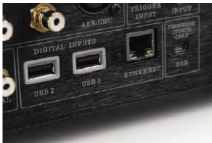
Cyfrowe wejścia USB kojarzą się natychmiast z trybem USB-DAC, ale w tym przypadku gniazda te służą do bezpośredniego podłączenia nośników pamięci z muzyką.
