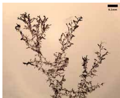
Fot. 5 – Dendryty miedzi pod mikroskopem
