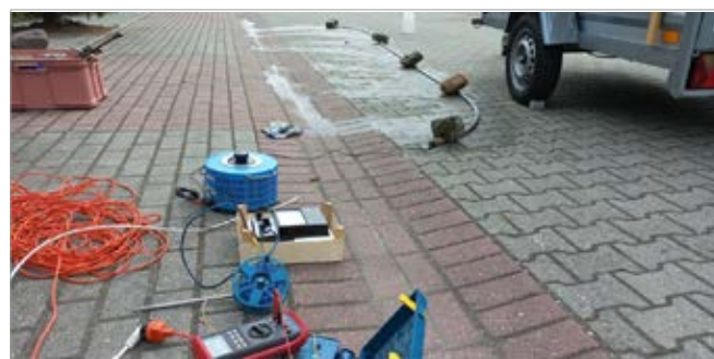
Przykład praktycznej realizacji pomiarów rezystancji przejścia na gruncie o dużej rezystywności (kostka brukowa) fot. M. Kielboń
