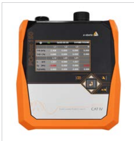
Fot. 1. Widok analizatora jakości energii elektrycznej PQ-BOX 150 firmy A-Eberle z ekranem prezentującym podstawowe parametry pomiarowe, takie jak: napięcie międzyfazowe, współczynnik THD dla napięcia i prądu, moc czynna i bierna oraz parametry jakości energii
