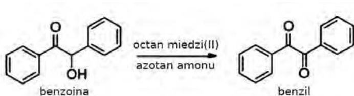
Rys. 3 – Schemat reakcji syntezy benzilu
