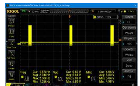
Rysunek 6. Prawidłowy oscylogram na wyjściu interfejsu RS485
