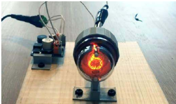
Fotografia 1. Działająca lampa Nixie z zaświeconym segmentem nr 6
