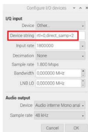
Rysunek 7. Konfiguracja GQRX do odbioru w paśmie HF
