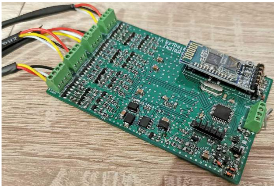
Fotografia 1. Zmontowana płytką PCB od strony TOP
