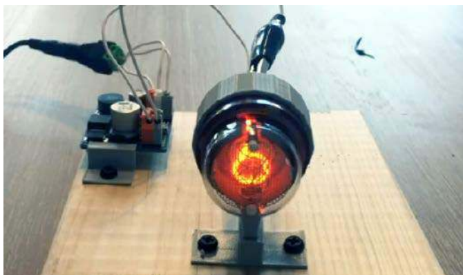
Fotografia 1. Działająca lampa Nixie z zaświeconym segmentem nr 6
