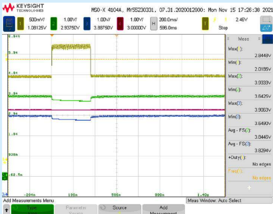
Rysunek 4. Impuls pomiarowy MPPT układu SPV1050
