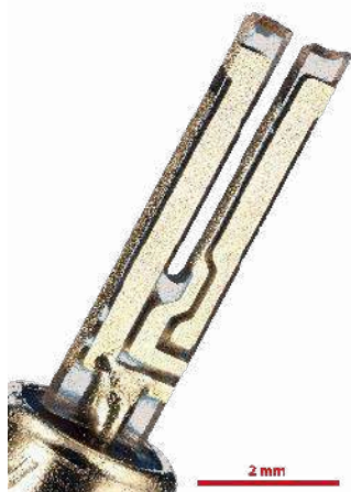
Fotografia 5. Płytkę kwarcową rezonatora „zegarkowego” typu tuning fork ( https://bit.ly/3phqlwd )
