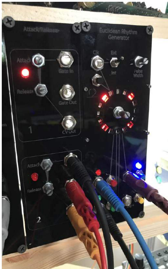
Fotografia 6. Gotowy moduł, zainstalowany i podłączony w syntezatorze
