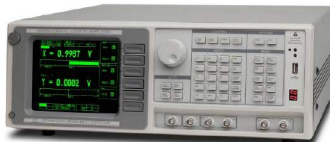
Fotografia 2. Wzmacniacz fazoczuły SR850 marki Stanford Research Systems ( https://bit.ly/32qNfbY )
