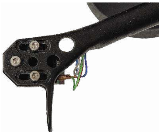
Sposobem Regi wkładka mocowana jest za pomocą trzech (a nie dwóch) śrub
