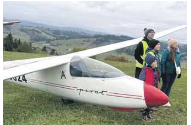
Pirat, wygląda zupełnie jak współczesna maszyna, a jest zrobiony głównie z cieniutkiej sklejki.
