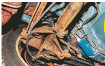
Z tyłu pracuje archaiczny sztywny most. Ale całkiem wytrzymały.
