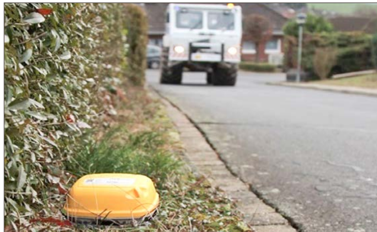
Na terenach, gdzie poszukiwane są złoża montowane są niewielkie żółte czujniki o wymiarach 10x10 cm.
