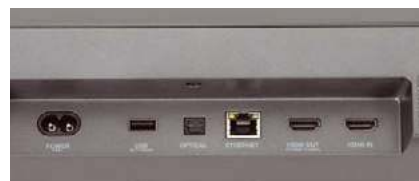
Wejście HDMI jest tylko jedno, ale najważniejsze jest wyjście z protokołem eARC.
