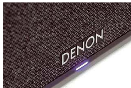
Niebieska (gdy wszystko „gra”) dioda jest stałym elementem wielu urządzeń HEOS; zmieniając kolor, sygnalizuje np. problem z połączeniem sieciowym.
