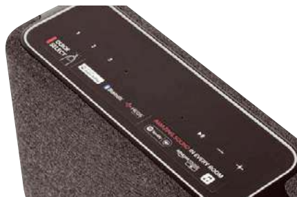
Na górnym panelu zainstalowano nowoczesny układ sensorów dotykowych.
