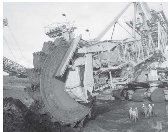
Koparka węglowa SRs 2000 podczas pracy
