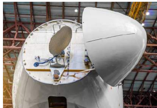
Radary meteorologiczny Dopplera montowany w nosie samolotu
