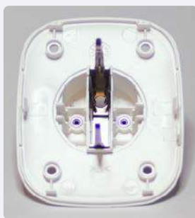
Rysunek 10. Trudno dostępny montaż płytki drukowanej w EU6S
