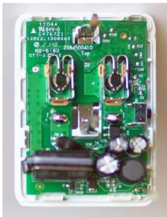
Rysunek 27. Kotki zasilające na środku są przylutowane
