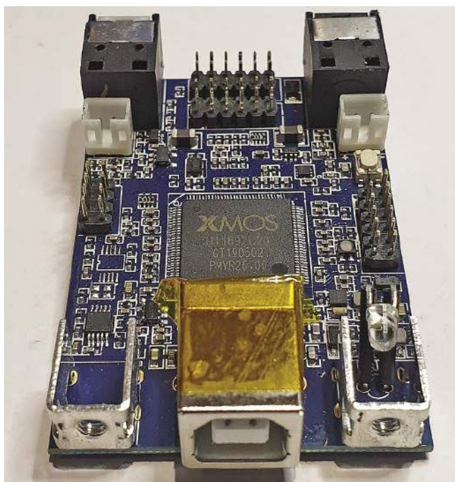
Odcinek taśmy poliimidowej Kapton na obudowie gniazda USB MCHStreamera zapewnia, że nie ma ono możliwości zwarcia z żadnymi elementami na głównej płycie drukowanej Super-Kodeka.
