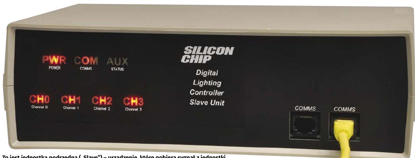
To jest jednostka podrzędna („Slave”) – urządzenie, które pobiera sygnał z jednostki sterującej i zasilają dołączone światła. Sterownik główny opisujemy w przyszłym miesiącu.
