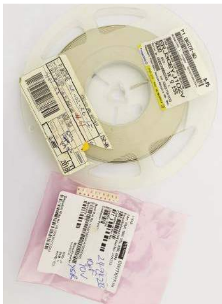
Rysunek 5. Przykłady elementów na taśmie szpuliowej i ciętej
