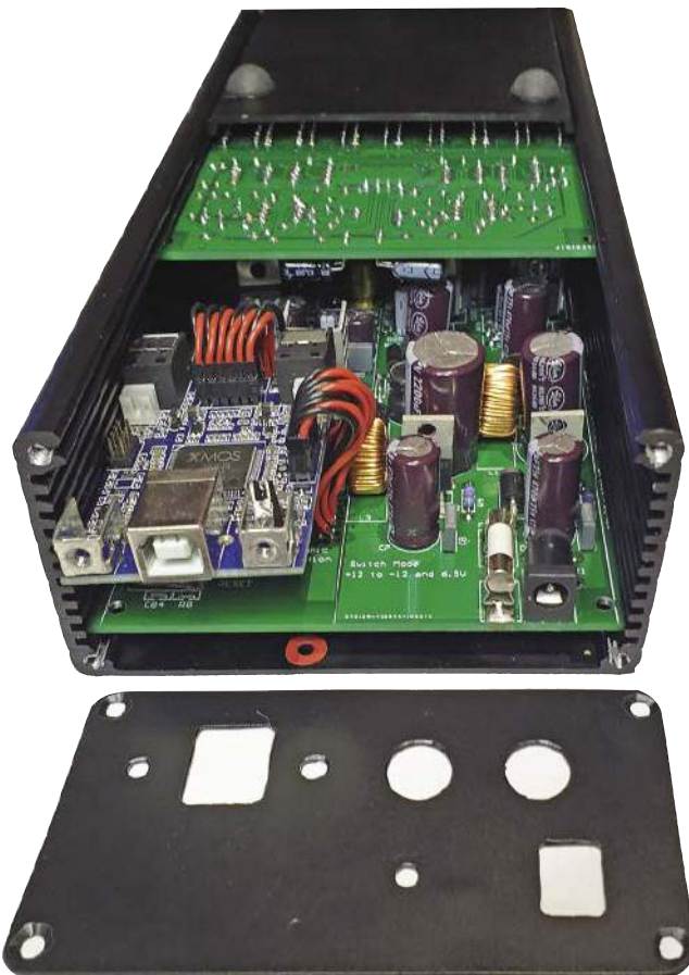
A oto widok z przeciwnego końca, ze zdjętą pokrywą, pokazujący, jak nowa płytka drukowana lokuje się „do góry nogami” nad istniejącą płytką Super-Kodeka
