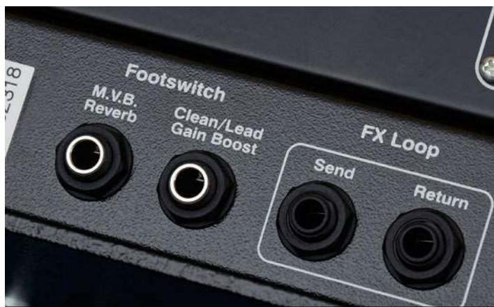
Dwa wyjścia podwójnych przełączników nożnych udostępniają dwa rodzaje podbić z poziomu stopy- gainu i głośności, zmianę kanałów i włączanie pogłosu.
