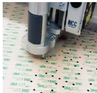
Rysunek 6. Błona klejowa w ploterze tnącym podczas wycinania elementów samoprzylepnych (konwertingu) do dalszego zastosowania
