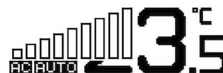
Rysunek 12. Wygląd graficznego interfejsu użytkownika urządzenia Climatic II w trakcie regulacji prędkości wentylatora
